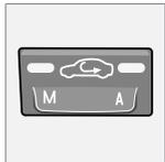
Questa funzione blocca l'ingresso di aria inquinata, gas di scarico ecc. nell'abitacolo. Quando la funzione è attivata, l'aria nell'abitacolo entra in ricircolo, cioè non viene immessa aria esterna nell'automobile. Se l'aria nell'automobile ricircola per troppo tempo, potrebbe formarsi condensa all'interno dei finestrini.
