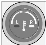
La temperatura del lado del conductor y del lado del acompañante puede ajustarse independientemente.
