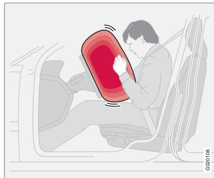
Como complemento del cinturón de seguridad, el automóvil está equipado con un airbag o SRS (Supplemental Restraint System). El airbag está plegado en el centro del volante. El volante lleva estampadas las letras **SRS AIRBAG**.
