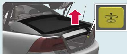
Levante/baje la capota para facilitar la colocación de la carga.
