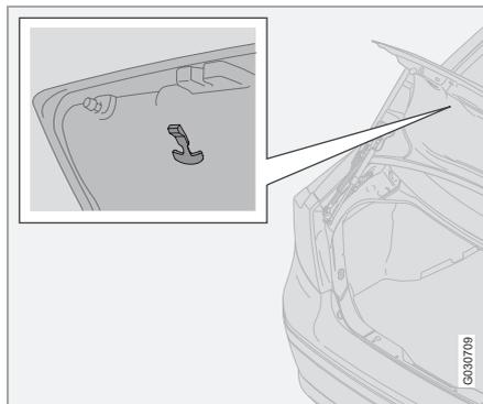
Le véhicule est équipé d'une poignée fluorescente sur la partie interne du couvercle du coffre; cette poignée permet d'ouvrir le coffre de l'intérieur en cas d'urgence.
