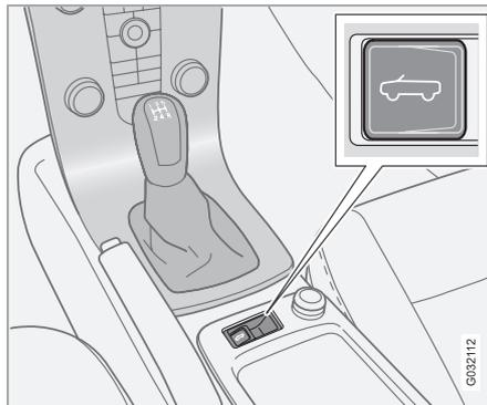
Bouton du toit rigide rétractable électrique
