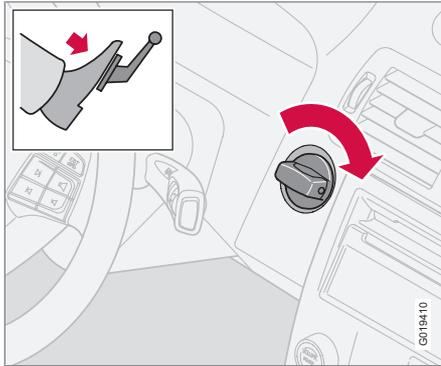
Le démarrage sans clé permet de déverrouiller, de démarrer et de verrouiller le véhicule sans l'aide d'une clé-télécommande.
