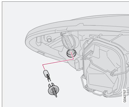
1. Tourner le support de l'ampoule dans le sens antihoraire et le retirer, puis remplacer l'ampoule.
