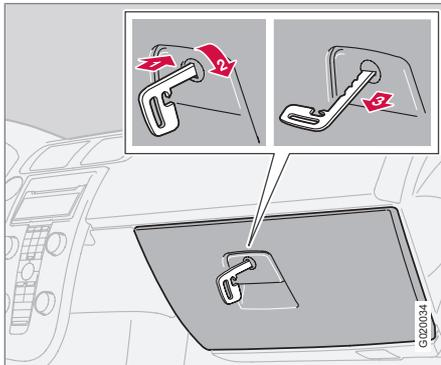
La boîte à gants peut être verrouillée et déverrouillée uniquement à l'aide de la clé intégrée démontable de la clé-télécommande, voir page 139 pour de plus amples renseignements sur la manière de retirer la clé intégrée de la clé-télécommande.
