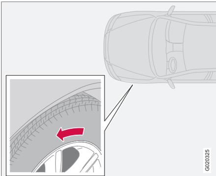
Les flèches indiquent le sens de rotation du pneu
