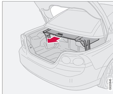
La cloison de séparation du coffre indique la quantité de bagages que le coffre peut contenir sans nuire au mouvement du toit rigide rétractable électrique.
