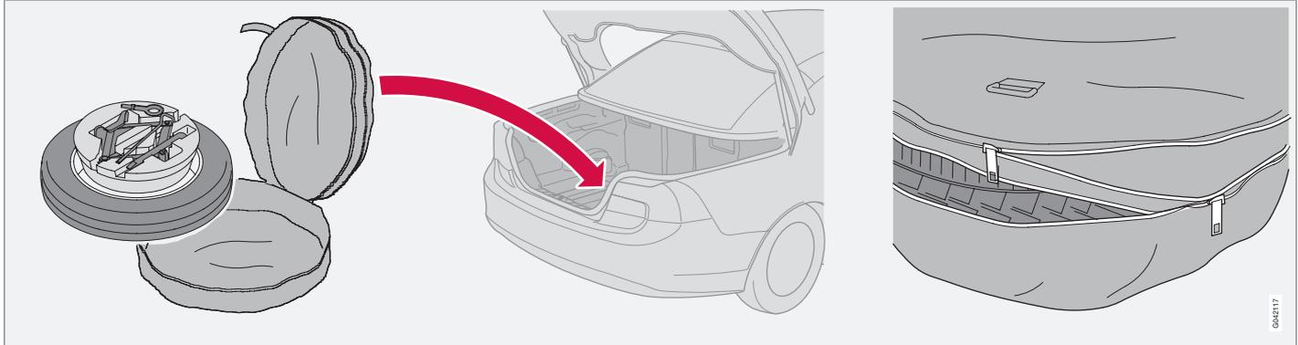
*Pneu de secours et outils (les outils sont rangés au même endroit sur les modèles équipés du système d'obturation de pneu)*
