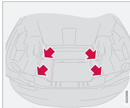
Les œillets d'ancrage à l'intérieur du coffre peuvent servir à attacher des sangles de charge et de fixation d'accessoires, des filets d'arrimage et d'autres dispositifs d'ancrage.
