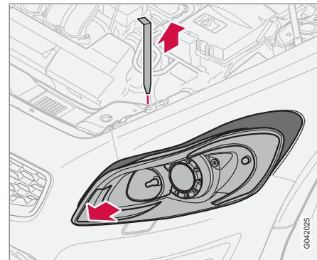
Il faut enlever le boîtier du phare complet lorsqu'on remplace les ampoules des feux de croisement/route, des feux de stationnement, des clignotants et des feux de position latéraux. Pour retirer le boîtier :
