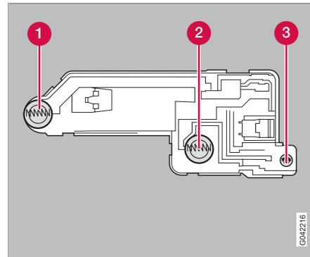
Emplacement des ampoules des feux arrière
