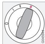
Tourner la clé à cette position et la relâcher immédiatement. La clé revient automatiquement à la position de conduite.
