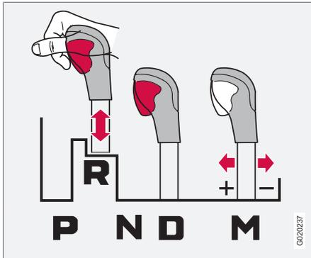
Appuyer sur le bouton situé à l'avant du levier de vitesses pour passer entre les positions **R**, **N**, **D** et **P**.
