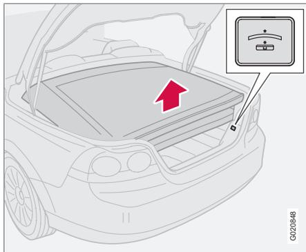
Bouton de changement de niveau du toit rigide rétractable électrique replié
