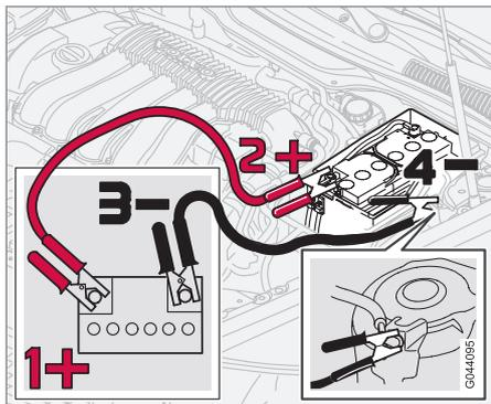
Suivre ces instructions pour charger la batterie de votre véhicule, ou celle d'un autre véhicule, au moyen d'une batterie auxiliaire. Si la batterie auxiliaire de 12 volts à utiliser est sur un autre véhicule, il faut vérifier que les véhicules ne se touchent pas pour éviter une fermeture prématurée du circuit. S'assurer de suivre les instructions d'utilisation de la batterie auxiliaire de l'autre véhicule.
