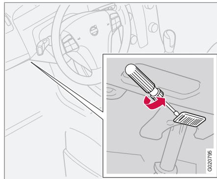
L'éclairage de seuil des portières est situé sous le tableau de bord du côté conducteur et passager. Pour remplacer une ampoule :
