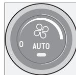
La fonction **AUTO** régle automatiquement la circulation d'air afin de maintenir la température désirée. La fonction automatique règle le chauffage, la circulation d'air, la vitesse du ventilateur, la
