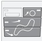
Appuyer sur l'un des trois boutons indiqués dans l'illustration pour activer le débit d'air sélectionné. Un symbole apparaissant à l'écran au-dessus du panneau de commande de la climatisation et la
