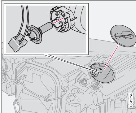
Ampoule halogène de feu de route
