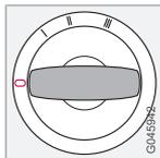
Retirer la clé pour verrouiller le volant<sup>1</sup>. Ne jamais tourner la clé sur la position **0** pendant la conduite ou lorsque le véhicule est remorqué.
