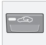
On peut utiliser cette fonction pour empêcher que les gaz d'échappement, la fumée, et autre ne pénètrent à l'intérieur de l'habitacle. L'air de l'habitacle est alors recirculé, c.-à-d. qu'il n'y a pas d'air de l'ex-
