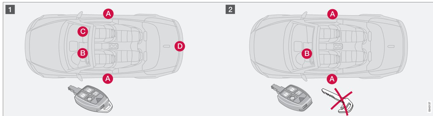
**1** Points de verrouillage/déverrouillage pour la clé-télécommande avec la clé intégrée en place (verrouillage en mode voiturier non activé) :
