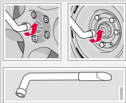
Démonte-roue équipé d'une poignée télescopique
