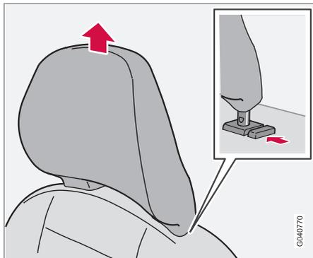
Les appuie-tête des sièges avant sont conçus de façon à pouvoir être placés en deux positions différentes.
