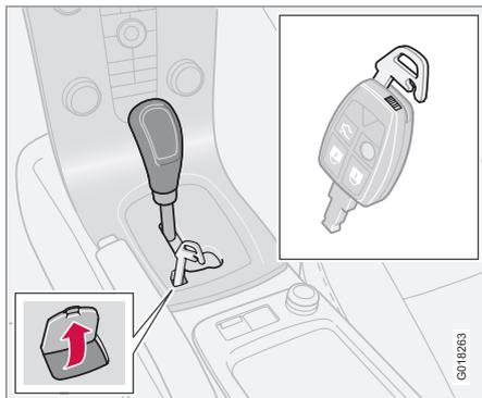
Le verrouillage du levier de vitesses empêche le levier d'être déplacé de la **P** position, à moins que la clé soit sur la position **II** et que la pédale de frein soit enfoncée.
