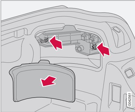
Toutes les ampoules du bloc de feux arrière peuvent être remplacées à partir du coffre. Pour accéder aux supports d'ampoule :
