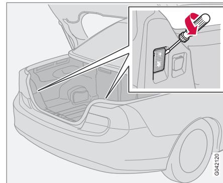
1. Insérer doucement un tournevis et sortir la lentille.
