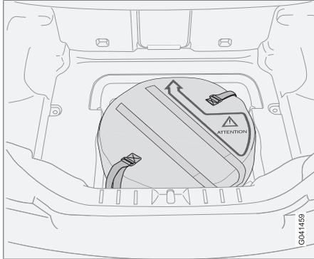
1. Baisser le cric de façon à ce qu'on puisse le placer dans sa position d'entreposage dans le bloc de styromousse.
