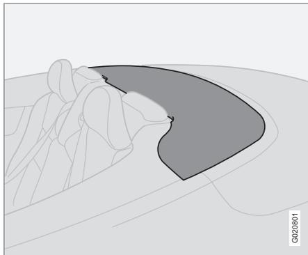
Une fois abaissé, le toit rigide rétractable électrique est protégé par une couverture, voir l'illustration.
