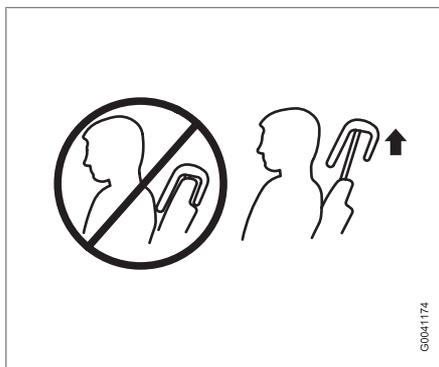
Le bord supérieur de l'appuie-tête doit au moins être au même niveau que le haut de l'oreille de la personne assise sur le siège (voir l'illustration).
