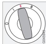
La position de la clé pendant la conduite. L'ensemble du système électrique du véhicule est activé.
