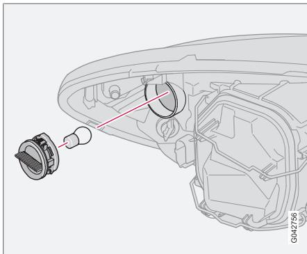
1. Tourner le support de l'ampoule dans le sens antihoraire et le retirer.
