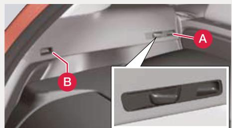
Die eine hintere Sperre bei (B) anbringen und den Sperrknopf nach vorn drücken. Die drei verbleibenden Punkte in gleicher Weise sichern.
