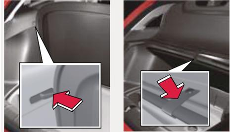
Bodenklappe in offener Stellung mit bzw. ohne Sichtschutz.
