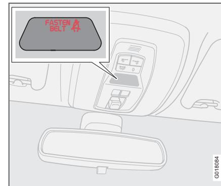
Un rappel lumineux et sonore incite les personnes qui n'ont pas bouclé leur ceinture de sécurité de le faire. Le rappel sonore dépend de la vitesse et parfois du temps. Le rappel lumineux est situé dans la console du plafond et dans le combiné d'instruments.
