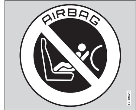
Autocollant placé sur le côté du tableau de bord.
