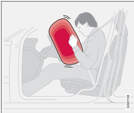
En complément des ceintures de sécurité, la voiture est équipée d'un coussin gonflable du côté conducteur SRS (Supplemental Restraint System - système de retenue supplémentaire). Le coussin gonflable est plié au centre du volant. Le volant porte l'inscription **SRS AIRBAG**.
