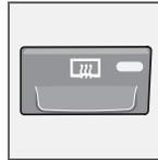
Ce bouton est utilisé pour dégivrer et désembuer rapidement la lunette arrière et les rétroviseurs extérieurs. Une pression sur le bouton active le chauffage simultané de la lunette arrière et
