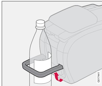
La console du tunnel comporte un porte-bouteille pour les bouteilles plus grosses.
