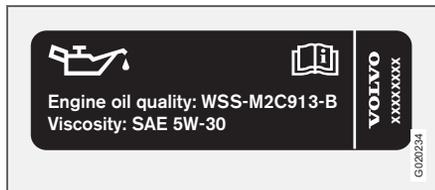
La présence de l'autocollant ci-contre dans le compartiment moteur indique les informations suivantes. Voir l'emplacement de l'autocollant en page 224.
