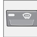
Cette fonction permet de dégivrer et de désembuer rapidement le pare-brise et les vitres latérales. Dirigez le flux d'air sur les vitres en utilisant une vitesse de ventilation élevée. La diode du bouton de dégivrage s'allume lorsque la fonction est connectée.
