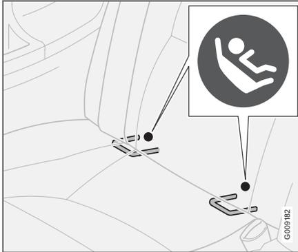
Les points de fixations du système ISOFIX sont dissimulés dans la partie inférieure du dossier de la banquette arrière, aux places extérieures.
