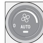
Gire el mando para aumentar o reducir la velocidad del ventilador. Si se selecciona el modo **AUTO**, la velocidad de ventilación se regula automáticamente. La velocidad ajustada anteriormente se desconecta.
