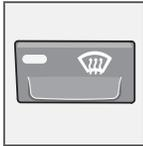
Se utiliza para eliminar rápidamente el vaho y el hielo del parabrisas y las ventanillas laterales. Las ventanillas se ventilan a alta velocidad. Cuando está conectada esta función, se enciende la luz del botón del desempañador.
