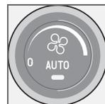
La función **AUTO** regula automáticamente el climatizador para obtener la temperatura seleccionada. La función automática regula la temperatura, el aire acondicionado, la velocidad del ventilador, la recirculación y la distribución del aire. Al seleccionar una o varias funciones manuales, las demás funciones siguen regulándose automáticamente. Cuando se pulsa el botón **AUTO**, se desconectan todos los ajustes manuales. En la pantalla aparece el texto **CLIMAT AUTOM.**
