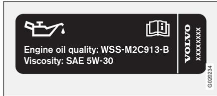
Cuando esta placa de características está instalada en el compartimento del motor, se especifica lo siguiente. Compruebe el emplazamiento de la placa en la página 224.
