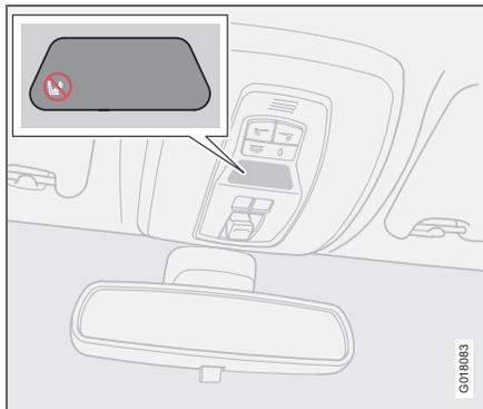
Indicación que muestra que el airbag (SRS) del acompañante está conectado.
