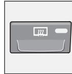
Utilice la función de calefacción eléctrica para hacer desaparecer el hielo y el vaho de la luneta trasera y los retrovisores. Si pulsa el botón una vez, se inicia el calenta-
