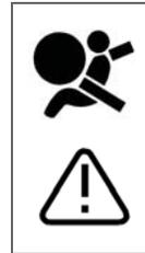
Junto con el símbolo de advertencia aparece, en caso necesario, un mensaje en la pantalla. Si el símbolo de advertencia no funciona, se enciende el triángulo de advertencia y aparece en la pantalla el mensaje **AIRBAG SRS REVISIÓN NECES.** o **AIRBAG SRS REVISIÓN**
