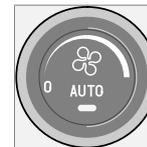
Ruotare il pomello per aumentare o ridurre la velocità della ventola. Selezionando **AUTO**, la velocità della ventola si regola automaticamente. La velocità della ventola impostata precedentemente si disattiva.
