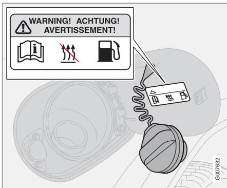
Disattivare sempre il riscaldatore a carburante prima del rifornimento.
