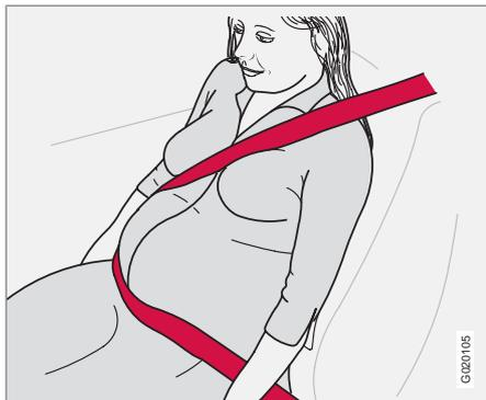
La cintura di sicurezza deve sempre essere utilizzata in gravidanza. Tuttavia è importante che sia utilizzata correttamente. La cintura deve essere aderente alla spalla, con la sezione diagonale tra i seni e a lato del ventre. La sezione lombare della cintura deve aderire al lato delle cosce, più bassa possibile al di sotto del ventre – non deve mai essere lasciata scivolare verso l'alto. La cintura deve aderire al corpo, senza gioco superfluo. Controllare inoltre che non sia attorcigliata.
