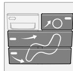
Premendo i pulsanti di distribuzione dell'aria, si può scegliere di orientare il flusso dell'aria verso finestrini, abitacolo e pavimento.
