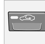
Il ricircolo previene l'ingresso nell'abitacolo di aria inquinata, gas di scarico ecc. L'aria nell'abitacolo entra in ricircolo, cioè non viene immessa aria esterna nell'automobile.
