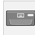
Utilizzare la funzione di riscaldamento per rimuovere il ghiaccio e la condensa da lunotto e specchi retrovisori. Premendo il pulsante una volta si attiva contemporaneamente il riscaldamento di
