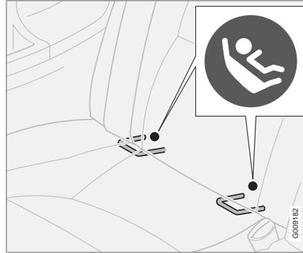
Gli attacchi per il sistema di fissaggio ISOFIX sono nascosti dietro la parte inferiore dello schienale del sedile posteriore, nei posti esterni.
