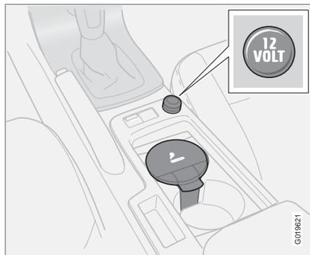
La prise électrique peut être utilisée pour alimenter divers accessoires 12 volts, par ex. un téléphone mobile ou une glacière. L'intensité maximale est de 10 A. La clé de contact doit être en position **I** pour que la prise soit alimentée.
