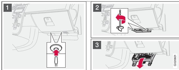
Le boîtier de fusibles contient 50 emplacements de fusible. Les fusibles sont situés sous la boîte à gants. Il existe aussi des emplacements pour les fusibles de recharge. Des outils pour le remplacement des fusibles se trouvent dans le boîtier du compartiment moteur, voir page 220.
