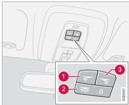
Commandes au plafond pour les liseuse avant et l'éclairage d'habitacle.
