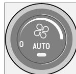
La fonction **AUTO** permet de réguler automatiquement la climatisation afin d'atteindre la température souhaitée. Cette fonction contrôle le chauffage, la climatisation, la ventilation, la recirculation et
