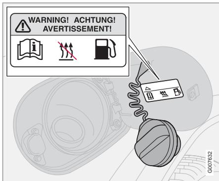
*N'oubliez pas de désactiver le chauffage au carburant avant le ravitaillement !*
