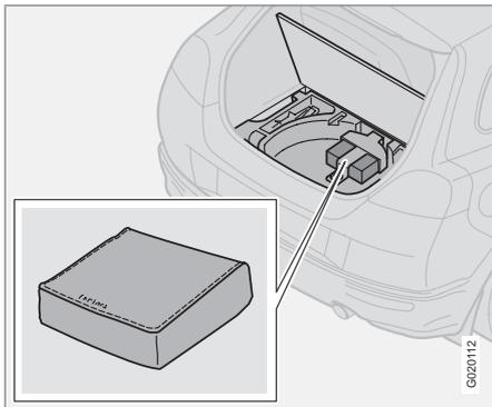
Le kit de réparation provisoire de crevaison permet de réparer une crevaison ou de contrôler et ajuster la pression de pneu. Il se compose d'un compresseur et d'un réservoir avec du liquide d'étanchéité. Le kit sert pour une réparation provisoire. Le flacon de liquide d'étanchéité doit être remplacé avant la date de péremption ou après utilisation.
