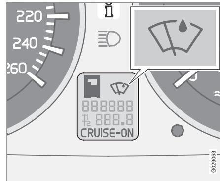
Le capteur de pluie détecte la quantité d'eau sur le pare-brise pour activer automatiquement les essuie-glace. La sensibilité du capteur de
