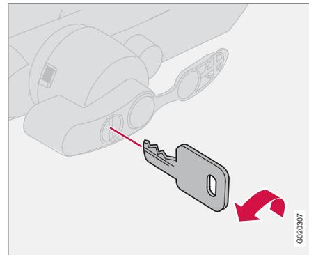
6. Tournez la clé dans le sens inverse des aiguilles d'une montre jusqu'en position de verrouillage. Retirez la clé de la serrure.
