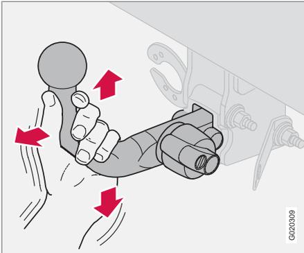
7. Contrôlez que la boule est bien fixée en la frappant vers le haut, le bas et l'arrière.
