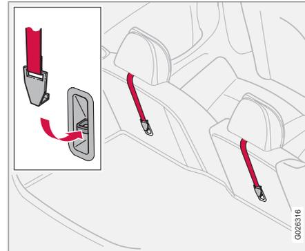
La voiture est équipée de points de fixations supérieurs pour sièges enfant. Ces points de fixation sont placés sur l'arrière de la banquette arrière.
