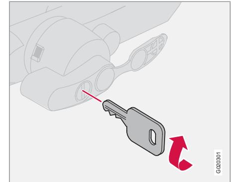
1. Insérez la clé et tournez-la dans le sens des aiguilles d'une montre en position déverrouillée.
