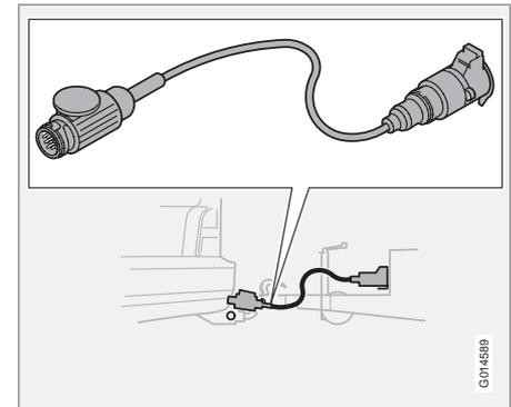
Si le connecteur électrique du crochet d'attelage de la voiture est à 13 broches et celui de la remorque est à 7 broches, un adaptateur sera nécessaire. Utilisez un câble d'adaptateur homologué par Volvo. Assurez-vous que le câble ne traîne pas sur le sol.
