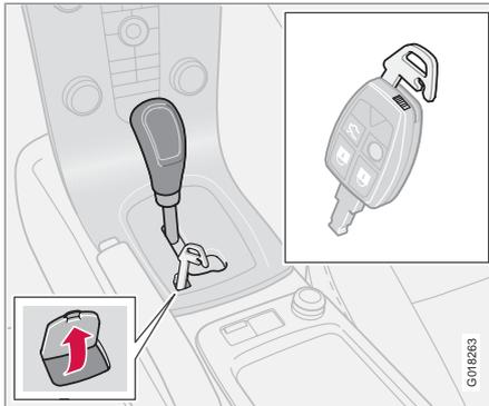
Dans certains cas, il peut être nécessaire de déplacer la voiture alors qu'elle ne peut être conduite, par ex. lorsque la batterie est déchargée. Procédez de la façon suivante pour déplacer la voiture :
