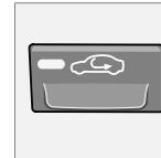
Vous pouvez choisir la recirculation d'air pour isoler l'habitacle de l'air vicié extérieur, des gaz d'échappement, etc. L'air de l'habitacle est recyclé. L'air extérieur ne pénètre pas dans la voiture lorsque
