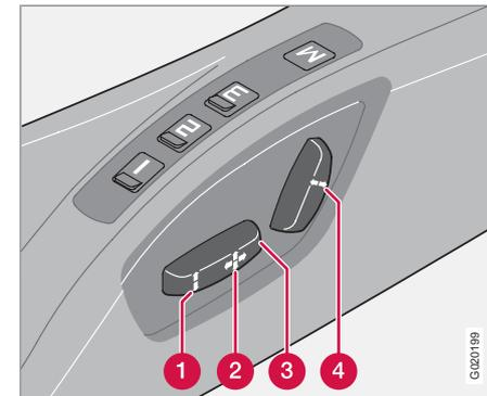
Il est possible de régler le siège un certain temps après avoir déverrouillé la porte avec la télécommande sans insérer la clé dans le contacteur d'allumage. Le siège peut toujours être réglé lorsque l'allumage est en position I ou II.
