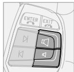
Le volume d'un appel est réglé avec les commandes au volant.
