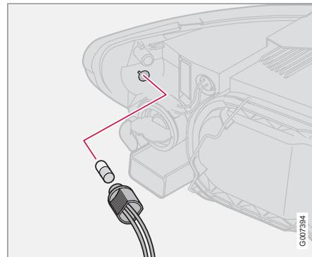
1. Dévissez l'ampoule dans le sens contraire des aiguilles d'une montre, retirez-la et remplacez l'ampoule.
