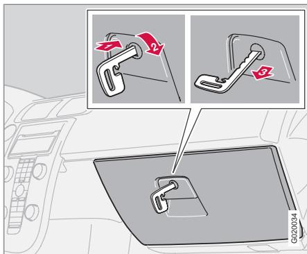
La boîte à gants ne peut être verrouillée/déverrouillée qu'à l'aide de la lame de clé de la télécommande. (Pour de plus amples informations sur la lame de clé, voir page 117.)
