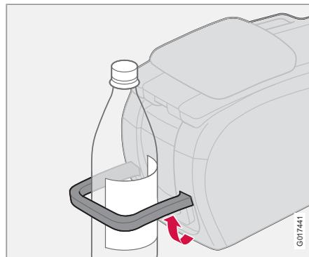
La console du tunnel comporte un porte-bouteille pour les bouteilles plus grosses.
