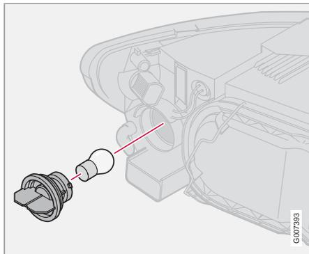
1. Dévissez la douille d'ampoule dans le sens contraire des aiguilles d'une montre et retirez-la.
