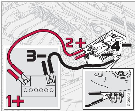
Si la batería en el automóvil se ha descargado, puede utilizarse la alimentación de una batería independiente o la batería de otro automóvil. Compruebe siempre que las pinzas de los cables puente estén bien sujetas para que no se generen chispas durante el intento de arranque.
