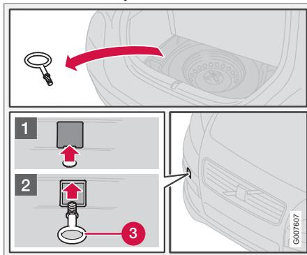
Utilice la anilla de remolque si es necesario remolcar el automóvil por la vía pública. La anilla de remolque se fija en la ranura situada en el lado derecho del parachoques delantero o trasero.
