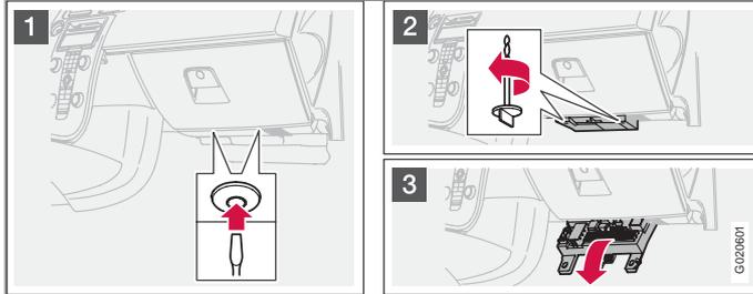
Tiene 50 posiciones de fusibles. Los fusibles están situados debajo de la guantera. También tiene espacio para fusibles de repuesto. La herramienta para el cambio de fusibles está en la caja de fusibles y relés, en el compartimento del motor, ver la página 222.
