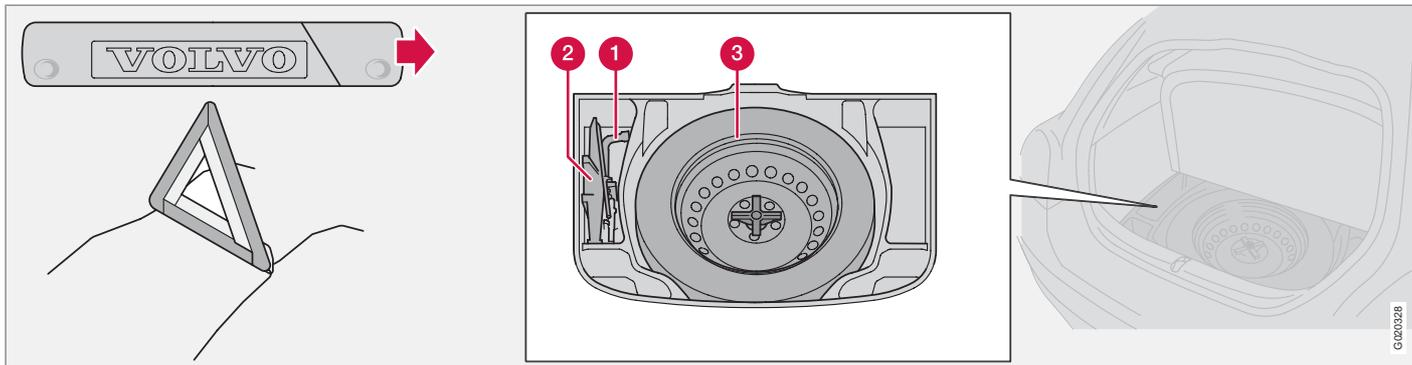
Siga las normas relativas al uso del triángulo de peligro\*. Coloque el triángulo en un lugar apropiado teniendo en cuenta las condiciones del tráfico.
