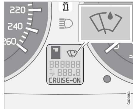
El sensor de lluvia detecta la cantidad de agua que cae sobre el parabrisas y activa los limpiaparabrisas de manera automática. La sensibilidad del sensor de lluvia se ajusta con la rueda (C), ver la página 61.
