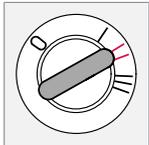
La posición de la llave para conducir. Está conectado el sistema eléctrico del vehículo.
