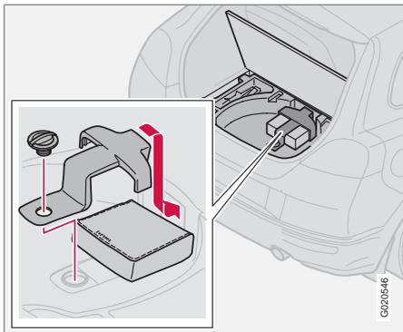
1. Colocar el kit de reparación de neumáticos.
