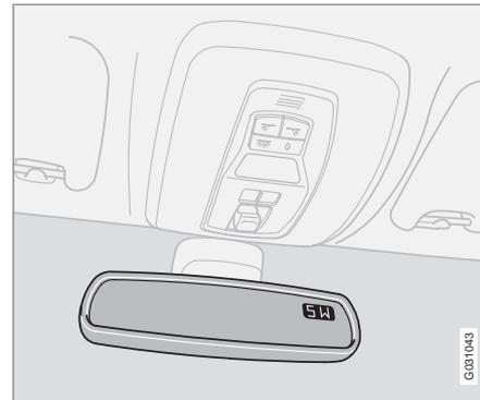
En la esquina superior derecha del retrovisor hay un display que indica el rumbo del automóvil. Se muestran ocho puntos cardinales con abreviaturas en inglés: **N** (norte), **NE** (noroeste), **E** (este), **SE** (suroeste), **S** (sur), **SW** (suroeste), **W** (oeste) y **NW** (noroeste).
