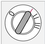
Pueden conectarse algunos componentes eléctricos. El sistema eléctrico del motor no está conectado.
