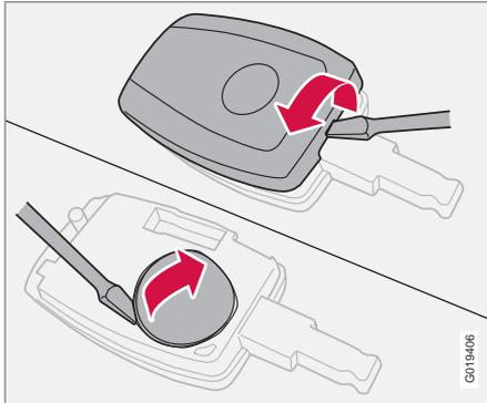
Si, a una distancia normal, los cierres no responden a las señales del mando a distancia, deberá cambiar la pila. (tipo CR 2450, 3 V).
