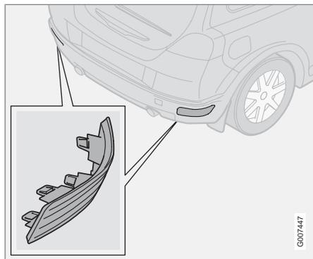
El catadióptrico está fijado con presillas y se fija presionándolo. Sólo puede colocarse de una manera.
