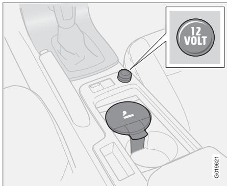
La toma eléctrica puede utilizarse con diversos accesorios previstos para una tensión de 12 V, por ejemplo, un teléfono móvil o una nevera. La intensidad máxima de corriente es de 10 A. Para que la toma suministre corriente, la llave de encendido debe estar como mínimo en la posición I.
