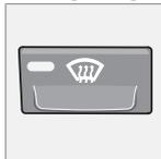
Pour dégivrer et débarrasser rapidement le pare-brise avant et les vitres latérales. Dirigez le flux d'air sur les vitres en utilisant une vitesse de ventilation élevée. La diode du bouton de dégivrage s'allume lorsque la fonction est connectée.
