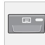
Ce bouton est utilisé pour dégivrer et débarrasser rapidement la lunette arrière et les rétroviseurs extérieurs. Une pression sur le bouton active le chauffage simultané de la lunette arrière et des rétroviseurs. Une diode allumée sur le bouton indique que la fonction est activée.
