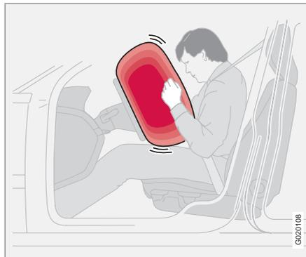
En complément de la ceinture de sécurité du côté conducteur, la voiture est équipée d'un coussin gonflable SRS (Supplemental Restraint System - système de retenue supplémentaire). Le coussin gonflable est plié au centre du volant. Le volant porte l'inscription **SRS AIRBAG**.
