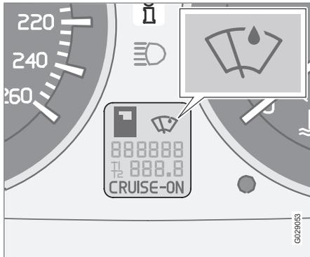
Il sensore pioggia rileva la quantità di acqua sul parabrezza e attiva automaticamente i tergicristalli. La sensibilità del sensore pioggia si regola con la rotella (2), vedere pagina 69.
