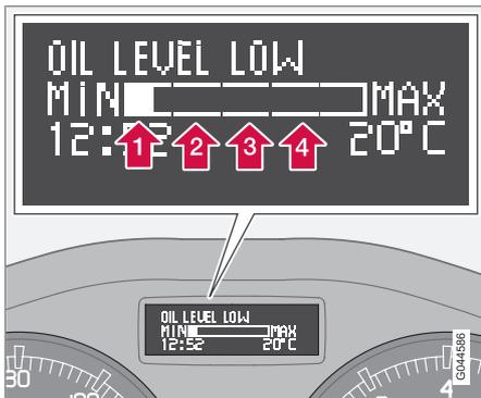
I numeri 1-4 indicano il livello di riempimento. Non rabboccare olio se è visualizzato il livello di riempimento (3) o (4). Il livello di riempimento raccomandato è 4.
