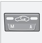
Questa funzione blocca l'ingresso di aria inquinata, gas di scarico ecc. nell'abitacolo. Quando la funzione è attivata, l'aria nell'abitacolo entra in ricircolo, cioè non viene immessa aria esterna nell'au-
