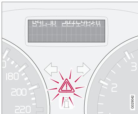
Se l'automobile è rimasta coinvolta in una collisione, potrebbe apparire il testo **MODO INCIDENTE VEDERE MANUALE** sul display informativo. Questo indica che la funzionalità dell'automobile è ridotta. Il modo incidente indica un dispositivo di protezione che interviene se la collisione è tale da danneggiare funzioni importanti dell'automobile, ad esempio le linee di alimentazione, i sensori di uno dei sistemi di protezione oppure l'impianto frenante.
