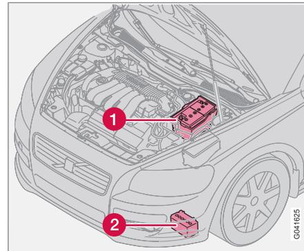
1. Batteria di avviamento<sup>2</sup> 2. Batteria ausiliaria.
