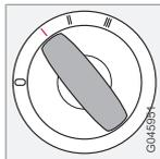
Bloccasterzo disattivato. È possibile utilizzare alcune funzioni. L'impianto elettrico del motore è disinserito.
