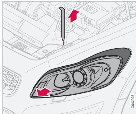
Tutte le lampadine a incandescenza anteriori (eccetto i fendinebbia) si sostituiscono staccando e rimuovendo l'intero alloggiamento attraverso il vano motore.
