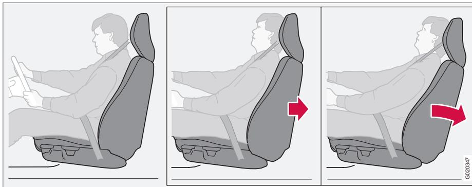
Il sistema WHIPS (Whiplash Protection System) comprende uno schienale capace di assorbire energia e un poggiatesta speciale sui sedili anteriori. Il sistema viene attivato in caso di tamponamento, secondo l'angolo di collisione, la velocità e le caratteristiche del veicolo che entra in collisione.
