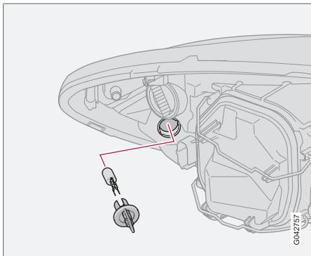
1. Ruotare il portalampadina in senso antiorario, estrarlo e sostituire la lampadina a incandescenza.
