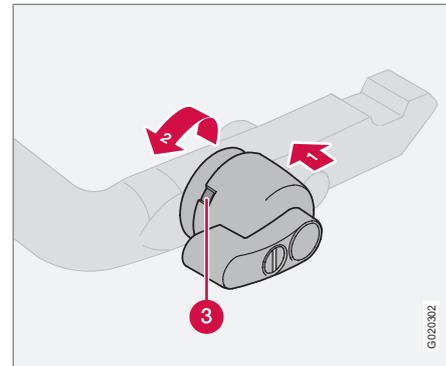
3. Controllare che la finestra di indicazione (3) sia rossa. In caso contrario, premere **1** e ruotare la manopola di bloccaggio in senso antiorario **2** finché non si sente un "clic".
