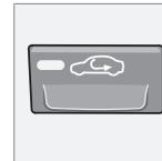
Il ricircolo previene l'ingresso nell'abitacolo di aria inquinata, gas di scarico ecc. L'aria nell'abitacolo entra in ricircolo, cioè non viene immessa aria esterna nell'automobile.
