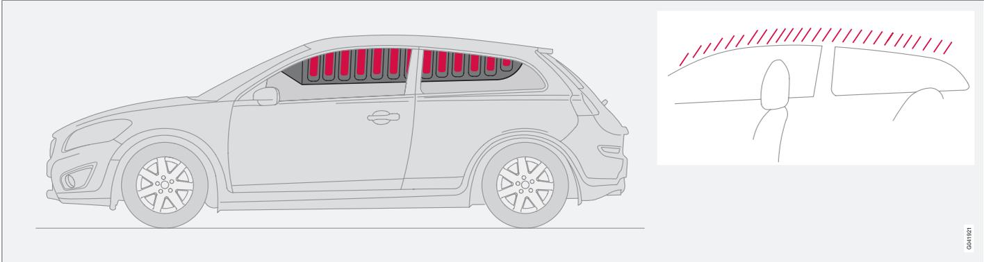
La tendina gonfiabile IC (Inflatable Curtain) fa parte del sistema SIPS e airbag. È montata nel padiglione su entrambi i lati dell'automobile e protegge i passeggeri nei sedili esterni. In caso di collisione sufficientemente forte, i sensori reagiscono gonfiando la tendina gonfiabile. La tendina gonfiabile contribuisce a proteggere la testa del conducente e dei passeggeri dai colpi contro l'interno dell'automobile in caso di collisione.
