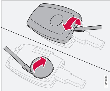
Se le serrature non reagiscono ripetutamente ai segnali provenienti dalla chiave telecomando a una distanza normale, sostituire la batteria (tipo CR 2450, 3 V).
