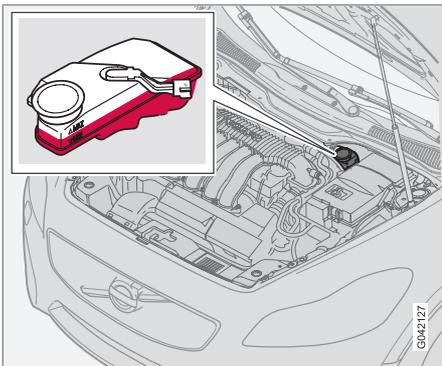
L'olio di freni e frizione utilizza lo stesso serbatoio<sup>4</sup>. Il livello deve essere compreso tra i marchi **MIN** e **MAX**. Controllare il livello regolarmente. Sostituire l'olio dei freni ogni due anni oppure ogni due tagliandi.
