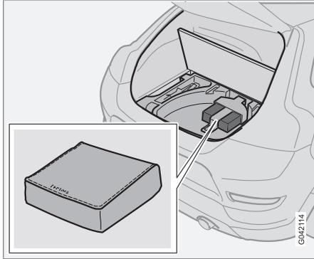
Il kit di riparazione pneumatici si utilizza per riparare una foratura nonché controllare e regolare la pressione pneumatici. Comprende un compressore e un contenitore con il composto sigillante. Il kit è progettato per una riparazione provvisoria. Il flacone con il composto sigillante deve essere sostituito entro la scadenza indicata e, comunque, dopo l'utilizzo del kit.
