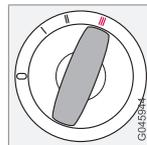
Il motorino di avviamento si attiva. La chiave telecomando viene rilasciata all'accensione del motore e ritorna automaticamente in posizione di marcia.
