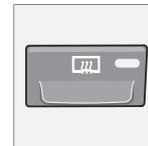
Utilizzare la funzione di riscaldamento per rimuovere il ghiaccio e la condensa da lunotto e specchi retrovisori. Premendo il pulsante una volta si attiva contemporaneamente il riscaldamento di lunotto e specchi retrovisori. Se la funzione è attiva, la spia sul pulsante è accesa.
