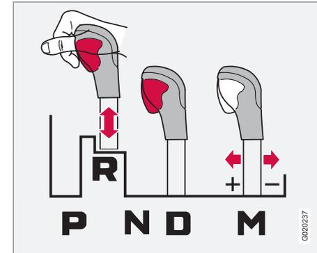
La leva può essere portata liberamente in avanti o all'indietro tra **N** e **D**. Le altre posizioni hanno un blocco che viene manovrato tramite il pulsante di bloccaggio sulla leva selettoria.
