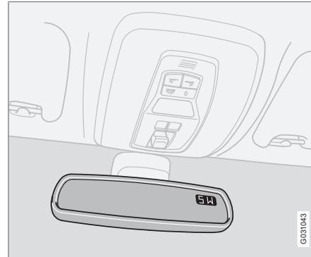
L'angolo superiore destro dello specchio retrovisore ha un display che visualizza il punto cardinale in cui è rivolta l'automobile. Sono visualizzate 8 diverse direzioni con abbreviazioni in inglese: **N** (Nord), **NE** (Nord Est), **E** (Est), **SE**
