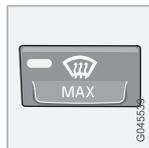
Si utilizza per rimuovere rapidamente condensa e ghiaccio dal parabrezza e dai finestrini. L'aria viene indirizzata sui cristalli a velocità elevata. Quando questa funzione è attivata, la spia sul pulsante
