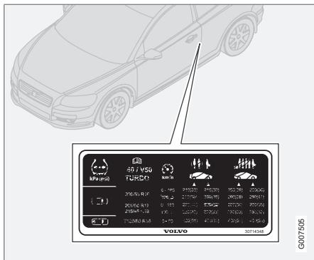
L'etichetta pressione pneumatici sul montante della portiera del conducente indica le pressioni dei pneumatici richieste in base al carico e alla velocità.
