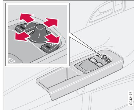
I comandi per la regolazione dei due specchi retrovisori esterni si trovano sull'estremità anteriore del bracciolo della portiera del conducente. Gli specchi retrovisori possono essere azionati con la chiave telecomando in posizione **I** o **II**.
