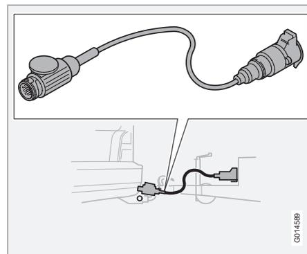
Se il dispositivo di traino è dotato di un connettore a 13 pin e il rimorchio di un connettore a 7 pin, è necessario un adattatore. Utilizzare un cavo adattatore approvato da Volvo. Accertarsi che il cavo non strisci per terra.
