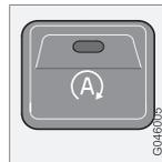
Il messaggio **MOTORE IN AUTO START** sul display e l'accensione della spia verde nel pulsante indicano che il motore si è spento automaticamente.
