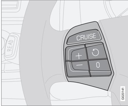
I comandi del regolatore elettronico della velocità si trovano sulla parte sinistra del volante.
