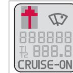
Il GSI - GearShift Indicator - indica al conducente il momento migliore per cambiare marcia. L'indicazione è fornita con una freccia di passaggio alla marcia superiore o inferiore sul display informativo
