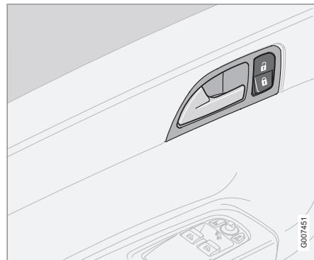
Con il pulsante della chiusura centralizzata nella portiera del conducente è possibile bloccare o sbloccare contemporaneamente le portiere e il portellone.
