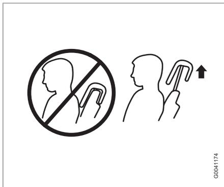
Les deux sièges arrière sont équipés d'un appui-tête pouvant être réglé à la verticale selon deux positions différentes en fonction de la taille du passager. Le bord supérieur de l'appui-tête doit au moins être au même niveau que le haut de l'oreille de la personne assise sur le siège (voir l'illustration).
