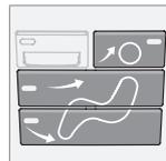
Appuyer sur l'un des trois boutons indiqués dans l'illustration pour activer le débit d'air sélectionné. Un symbole apparaissant à l'écran au-dessus du panneau de commande de la climatisation et
