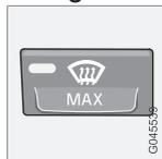
Pointe le débit d'air sur le pare-brise et les vitres latérales et augmente la vitesse du ventilateur. Lorsque le dégivreur est en marche :
