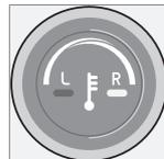
Les températures côté conducteur et côté passager peuvent être réglées séparément au moyen de la molette (identifiée par un symbole de thermomètre). La température peut être réglée pour les
