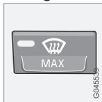
Pointe le débit d'air sur le pare-brise et les vitres latérales et augmente la vitesse du ventilateur.
