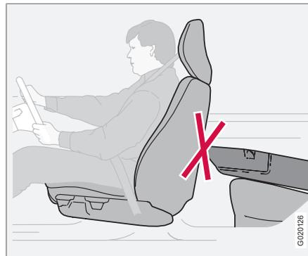
No coloque en el asiento trasero objetos que puedan impedir el debido funcionamiento del sistema WHIPS.
