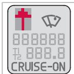
Como recurso auxiliar, el conductor cuenta con un indicador que le notifica el momento en que es más provechoso cambiar de marcha: GSI (Gear Shift Indicator).
