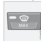
Para eliminar rápidamente el vaho y el hielo del parabrisas y de las ventanillas. Las ventanillas se ventilan a alta velocidad. Cuando está conectada esta función, se enciende la luz del botón del
