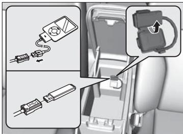
1. Soulever l'accoudoir et détacher le câble de connexion USB.
