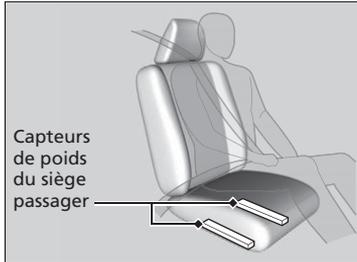
Le système avancé du coussin de sécurité gonflable avant du passager est muni de capteurs de poids.
