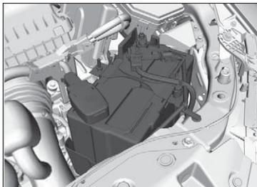
Tous les mois, vérifier la présence de corrosion sur les bornes de batterie.
