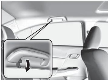
Le crochet à vêtement se trouve sur la poignée de maintien de gauche à l'arrière. Tirer sur le crochet vers le bas pour l'utiliser.
