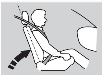
Redresser le dossier du conducteur à une position verticale confortable en laissant assez d'espace entre la poitrine et le couvercle du coussin de sécurité gonflable au centre du volant de direction.
