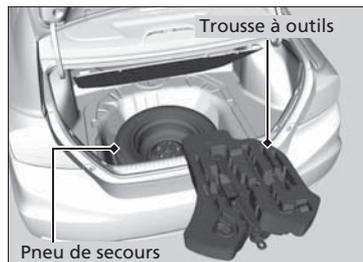
2. Sortir la trousse à outils du coffre. Sortir le cric et la clé pour écrou de roue de la trousse à outils.
