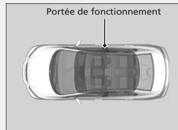
Le moteur peut être démarré lorsque la télécommande d'entrée intelligente est dans le véhicule. Le moteur peut aussi marcher si la télécommande d'entrée intelligente est à proximité de la portière ou de la glace, même si elle est à l'extérieur du véhicule.
