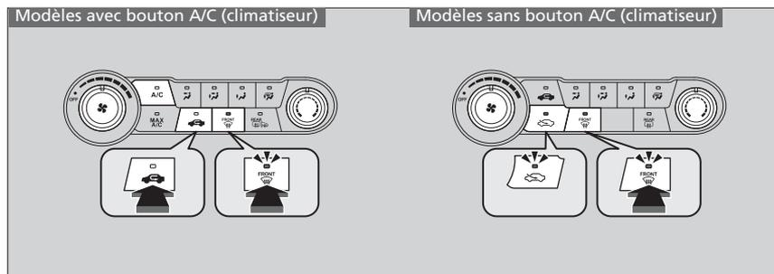
Le fait d'appuyer sur le bouton
