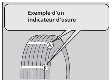
La rainure où l'indicateur d'usure est situé est 1,6 mm (1/16 po) plus étroite qu'ailleurs sur le pneu. Si la bande de roulement est usée de manière à exposer l'indicateur, remplacer le pneu. **Les pneus usés ont une mauvaise traction sur les routes humides.**
