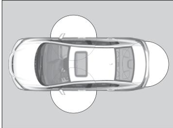
Lorsqu'on transporte la télécommande d'entrée intelligente avec soi, on peut verrouiller/déverrouiller les portières et ouvrir le coffre. Les portières peuvent être verrouillées/déverrouillées dans un rayon de 80 cm (32 po) de la poignée de portière extérieure. Le coffre peut être ouvert dans un rayon de 80 cm (32 po) du bouton de commande d'ouverture du coffre.
