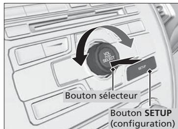
Appuyer sur le bouton **SETUP** (configuration), tourner pour sélectionner **Paramètres audio**, puis appuyer sur . Tourner pour faire défiler les choix disponibles :
