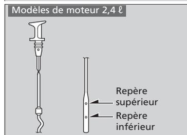
4. Sortir la jauge d'huile de nouveau et vérifier le niveau. Il doit être entre les repères supérieur et inférieur. Ajouter de l'huile au besoin.
