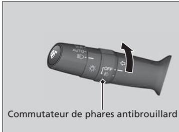
Les feux de croisement étant allumés, tourner l'interrupteur de phares antibrouillard pour utiliser les phares antibrouillard.
