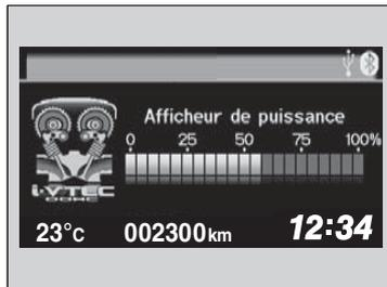
La puissance du moteur utilisée pendant la conduite s'affiche sur l'afficheur de puissance.
