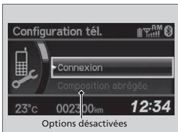
Certaines fonctions manuelles sont désactivées ou non-fonctionnelles lorsque le véhicule est en mouvement. Les options estompées en gris ne peuvent pas être sélectionnées tant que le véhicule n'est pas arrêté.
