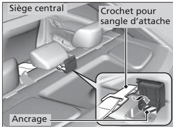
3. Fixer le crochet de la sangle d'attache dans l'ancrage.
