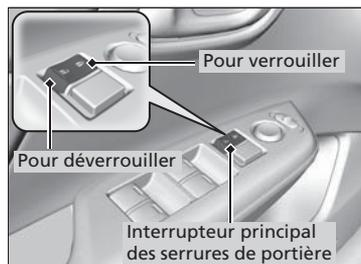
Appuyer sur l'interrupteur principal des serrures de portière conformément à l'illustration pour verrouiller ou déverrouiller toutes les portières.
