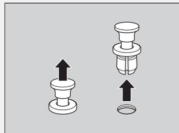
Maintenir la tête de l'agrafe soulevée au moment de l'insérer et pousser jusqu'à l'émission d'un déclic.
