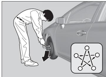
5. Baisser le véhicule et enlever le cric. Serrer les écrous de roue dans l'ordre indiqué sur l'image. Continuer de serrer les écrous, deux ou trois fois en alternance, dans cet ordre.
