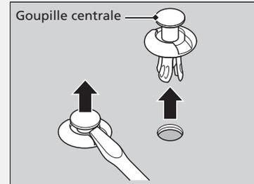
Insérer l'agrafe de retenue avec la goupille centrale relevée, puis pousser la goupille jusqu'à ce qu'elle soit enfoncée à plat.
