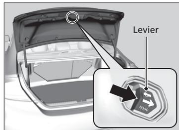
Pour une question de sécurité, le levier d'ouverture du coffre permet d'ouvrir le coffre de l'intérieur.
