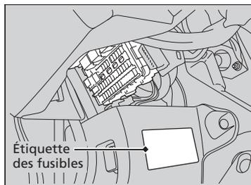
Les emplacements des fusibles apparaissent sur l'étiquette posée sur le panneau latéral.
