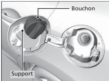
4. Dévisser lentement le bouchon du réservoir de carburant. Si on entend de l'air qui se libère, attendre que cela cesse, puis tourner le bouton lentement pour ouvrir le bouchon du réservoir de carburant.
