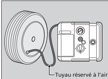
4. Attacher le boyau réservé à l'air au corps de la valve du pneu. Visser jusqu'à ce qu'il soit bien serré.
