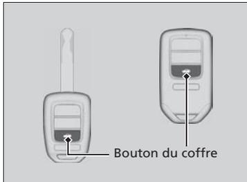
Appuyer sur le bouton d'ouverture du coffre pendant environ une seconde pour déverrouiller et ouvrir le coffre.
