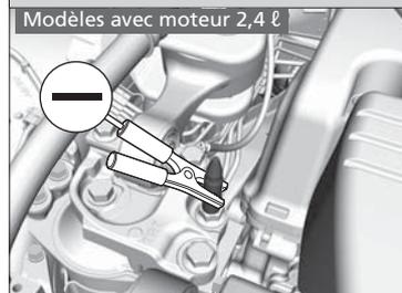
4. Connecter l'autre bout du deuxième câble volant au boulon de support de moteur tel qu'indiqué. Ne pas connecter ce câble volant à une autre pièce.
