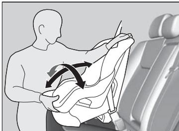
6. S'assurer que le siège de sécurité pour enfant est fermement fixé en tentant de le basculer d'avant en arrière et d'un côté à l'autre; on ne doit normalement ressentir qu'un léger mouvement.
