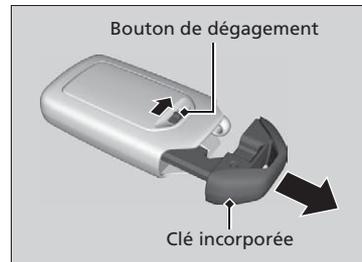
La clé incorporée peut être utilisée pour verrouiller/déverrouiller les portières et le coffre lorsque la pile de la télécommande d'entrée intelligente devient faible et que la fonction de verrouillage/déverrouillage électrique des portières est désactivée.
