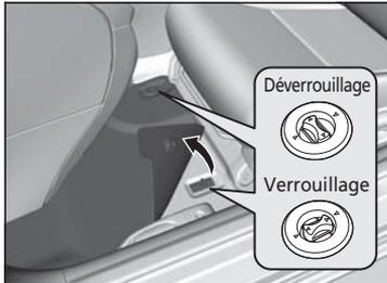
Le tapis de plancher du conducteur se fixe sur les ancrages de plancher, ce qui empêche le tapis de glisser vers l'avant. Pour retirer un tapis afin de le nettoyer, tourner les boutons d'ancrage à la position déverrouillée. Réinstaller les tapis suite au lavage du véhicule et tourner les boutons d'ancrage à la position verrouillée.
