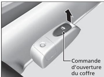
Le coffre se déverrouille et s'ouvre en tirant sur la commande d'ouverture du coffre, située sur la partie inférieure gauche du siège du conducteur.
