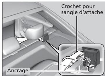
3. Ouvrir le couvercle de la sangle d'attache situé derrière l'appuie-tête.
