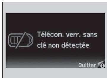
Les rappels sonores peuvent retentir à l'intérieur et/ou à l'extérieur du véhicule afin de rappeler au conducteur que la télécommande d'entrée intelligente est à l'extérieur du véhicule. Si la sonnerie continue de retentir même une fois que la télécommande est rapportée à l'intérieur du véhicule, placer la télécommande dans sa portée opérationnelle.
