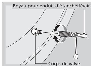
1. Retirer le bouchon de valve du corps de la valve du pneu.
