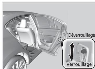
Glisser la détente de la portière arrière à la position de verrouillage et fermer la portière.
