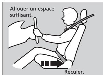
Régler le siège du conducteur le plus loin possible tout en se permettant la maîtrise absolue du véhicule. Il faut pouvoir s'asseoir en position droite, bien au fond du siège et pouvoir enfoncer adéquatement les pédales sans avoir à se pencher, et tenir le volant de direction confortablement. Le siège passager devrait être réglé de la même façon, de manière à ce qu'il soit le plus reculé possible par rapport au coussin de sécurité gonflable avant du tableau de bord.
