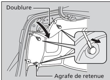
1. Retirer les agrafes de retenue à l'aide d'un tournevis à lame plate, puis enlever la garniture en la tirant.
