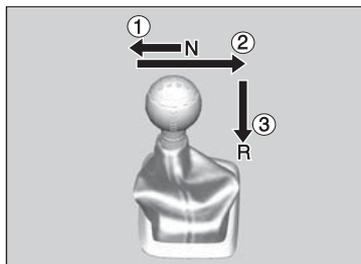
1. Enfoncer la pédale de débrayage, déplacer le levier de vitesses jusqu'à l'extrême gauche et passer à **R**.
