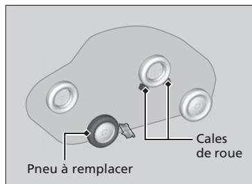
4. Placer une cale de roue ou une pierre en avant et en arrière de la roue en diagonale du pneu à plat.
