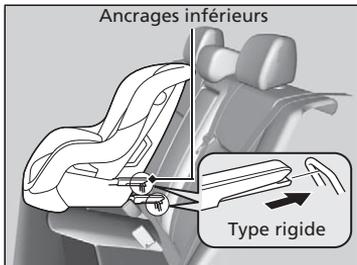
2. Mettre le siège de sécurité pour enfant sur le siège du véhicule, puis attacher le siège aux ancrages du bas conformément aux directives accompagnant le siège.
