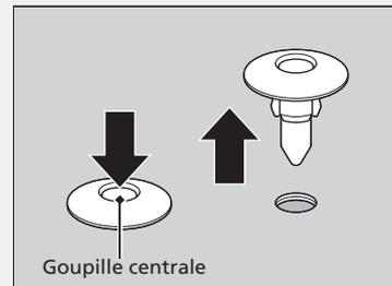
Pousser la goupille centrale de nouveau pour verrouiller l'agrafe. Ensuite, insérer l'agrafe dans le trou et pousser sur la goupille centrale jusqu'à ce qu'elle soit enfoncée à plat.
