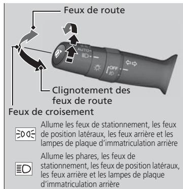
Tourner le commutateur de phares permet d'allumer et d'éteindre les phares, peu importe la position du commutateur d'allumage.
