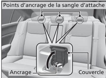
Un point d'ancrage de sangle d'attache se trouve derrière chaque place du siège arrière. En vue d'une sécurité accrue, on peut utiliser la sangle d'attache d'un siège de sécurité pour enfant qui est installé à l'aide d'une ceinture de sécurité.
