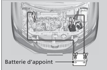
1. Connecter le premier câble volant à la borne de batterie  $\oplus$  du véhicule.
