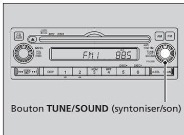
Appuyer sur le bouton **TUNE/SOUND** (syntoniser/son), et le tourner pour préciser le réglage.
