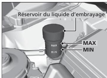
Le niveau du liquide doit être entre les repères **MIN** et **MAX** situées sur le côté du réservoir.
