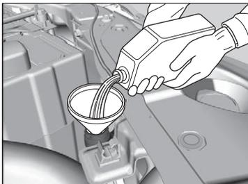
1. Vérifier le niveau du liquide de refroidissement dans le réservoir d'expansion.
