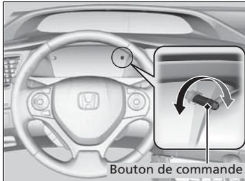
Lorsque les feux de stationnement sont allumés et que le commutateur d'allumage est en position MARCHÉ **[II]**\*1, le bouton de commande de luminosité peut être utilisé pour ajuster la luminosité du tableau de bord.
