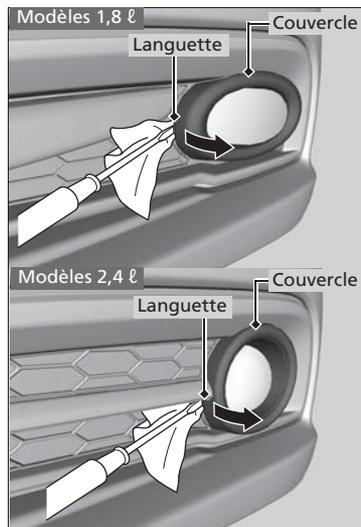
1. Insérer une tournevis à lame plate dans la languette du couvercle, puis tirer tout droit tel qu'indiqué pour retirer le couvercle.
