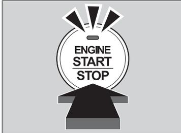
2. Enfoncer la pédale de frein (transmission à variation continue) ou la pédale de débrayage (boîte de vitesses manuelle) et appuyer sur le bouton **ENGINE START/STOP** (mise en marche/arrêt du moteur) dans les dix secondes qui suivent le signal sonore et alors que le témoin est allumé.
