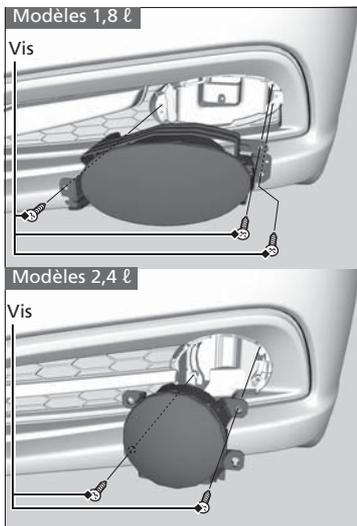
2. Enlever les vis à l'aide d'un tournevis cruciforme et retirer avec soin l'ensemble du phare antibrouillard hors du pare-chocs.
