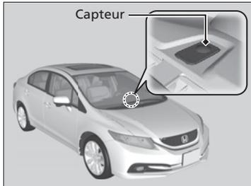
Le système de contrôle automatique de la température est muni de capteurs. Éviter de les recouvrir ou d'y renverser des liquides.
