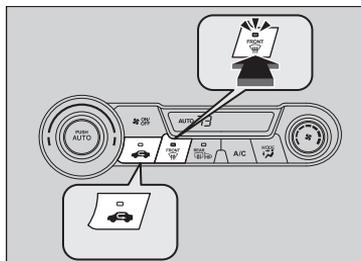
Appuyer sur le bouton
