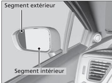
Le rétroviseur latéral du côté conducteur est muni d'un segment intérieur et d'un segment extérieur. Le segment extérieur est légèrement courbé afin d'offrir un angle visuel plus large que celui d'un rétroviseur plat standard. Cette vue élargie peut aider à mieux observer des angles autour du véhicule qui ne sont pas visibles avec un rétroviseur latéral standard.
