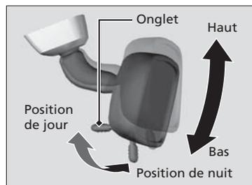
Basculer la languette pour changer la position. La position de nuit contribue à réduire l'éblouissement des phares des véhicules suivant derrière lors de la conduite de nuit.
