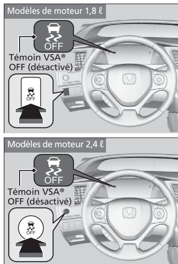
Ce bouton se trouve sur le panneau des commandes côté conducteur. Pour activer et désactiver le système VSA®, maintenir le bouton enfoncé jusqu'à l'obtention d'un signal sonore.
