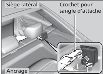
2. Soulever l'appui-tête à sa position la plus haute. Passer ensuite la sangle d'attache à travers les tiges de l'appui-tête. S'assurer que la sangle n'est pas tordue.
