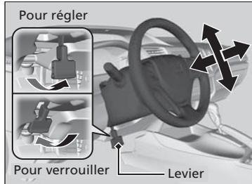
1. Relever le levier de réglage du volant de direction.
