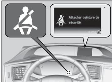
Le véhicule surveille l'utilisation des ceintures de sécurité avant. Si le commutateur d'allumage passe en position MARCHE **II**\*<sup>1</sup> avant que la ceinture de sécurité du conducteur ne soit bouclée, le signal sonore retentira et le témoin clignotera. Si le conducteur ne boucle pas la ceinture avant l'arrêt du signal sonore, le témoin restera allumé.
