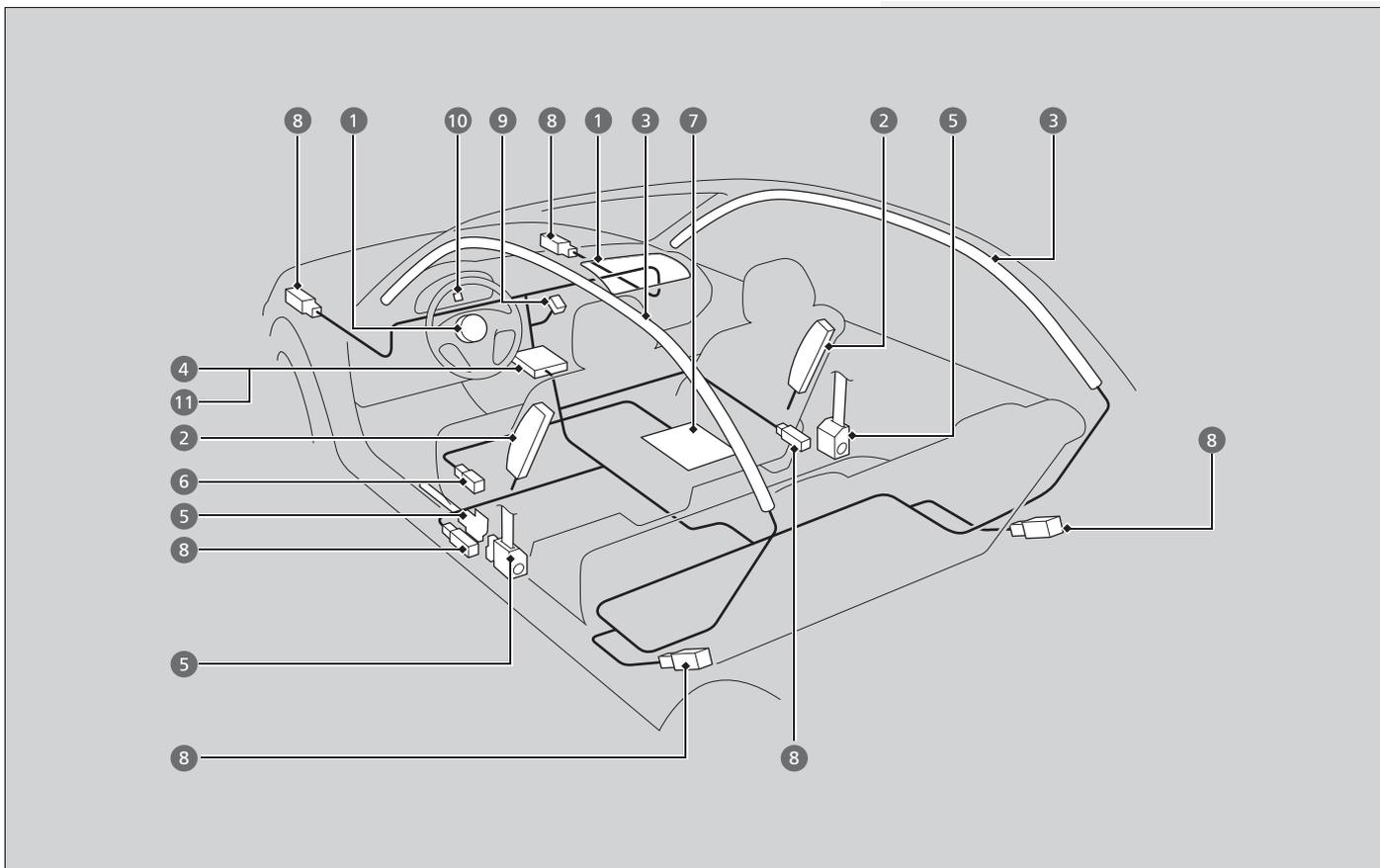
Les coussins de sécurité gonflables avant, les coussins de sécurité gonflables latéraux avant et les rideaux de sécurité gonflables latéraux se déploient en fonction de l'angle de collision et de sa gravité. Les deux rideaux de sécurité gonflables latéraux se déploient lors d'un capotage. Le système de coussins de sécurité gonflables inclut :
