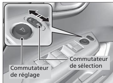
Les rétroviseurs latéraux peuvent être réglés lorsque le commutateur d'allumage est en position MARCHE
