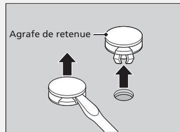
Insérer l'agrafe de retenue avec la goupille relevée, puis pousser la goupille jusqu'à ce qu'elle soit enfoncée à plat.
