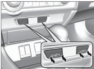
Le commutateur d'allumage doit être en position **MARCHE** **II**\*1 pour utiliser les chauffe-sièges. Le réglage **HI** (haut) réchauffe les sièges plus rapidement que le réglage **LO** (bas).
