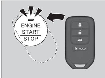
1. Toucher le centre du bouton **ENGINE START/STOP** (mise en marche/arrêt du moteur) avec le logo **H** sur la télécommande d'entrée intelligente pendant que le témoin clignote sur le bouton **ENGINE START/STOP**. Les boutons sur la télécommande d'entrée intelligente doivent faire face au conducteur.
