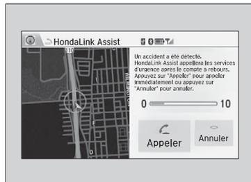
Si les coussins de sécurité gonflables se déploient ou si le système détecte que le véhicule a subi un choc important, le véhicule tentera automatiquement d'établir une connexion avec le service de téléphoniste HondaLink. Une fois la connexion établie, l'information concernant le véhicule, sa position et son état sera envoyé au service de téléphoniste; il sera également possible de parler avec le/la téléphoniste une fois connecté.
