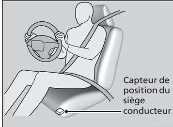
Le système avancé du coussin de sécurité gonflable avant du conducteur inclut un capteur de position du siège.
