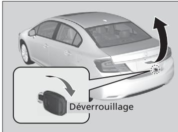
Insérer la clé dans le cylindre pour déverrouiller et ouvrir le coffre.
