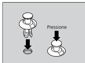
Insira a presilha com o pino central levantado e pressione-o até que fique nivelado com a presilha.
