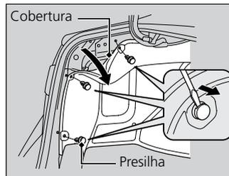
1. Remova as presilhas de fixação (D) ➡ P.172, usando uma chave de fenda, e puxe a cobertura para trás.
