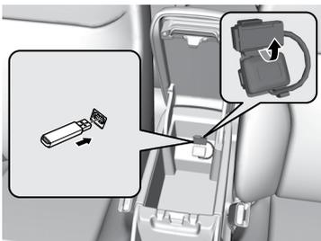
1. Levante o descanso-braço e desprenda o conector USB e solte o cabo adaptador.
