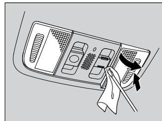
1. Usando uma chave de fenda, levante a borda da cobertura para removê-la.
