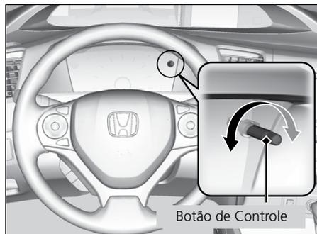
Quando o interruptor de ignição estiver na posição **LIGADA III**, é possível usar o botão de controle de iluminação para ajustar a iluminação do painel de instrumentos.
