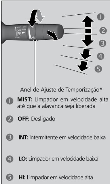
Os limpadores e lavadores do para-brisa podem ser usados quando o interruptor de ignição estiver na posição **LIGADA** [II].
