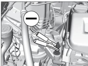
3. Conecte o segundo cabo auxiliar ao terminal  $\ominus$  da bateria auxiliar.
