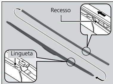
**4.** Deslize a palheta do limpador para fora do suporte, empurrando a extremidade da lingueta para fora.
