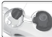
❹ Após reabastecer, encaixe a tampa do tanque de combustível e aperte-a até ouvir o ruído característico de travamento.
