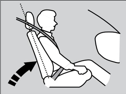
Ajuste o encosto do banco do motorista numa posição ereta e confortável, deixando amplo espaço entre o seu tórax e a tampa do airbag no centro do volante de direção.
