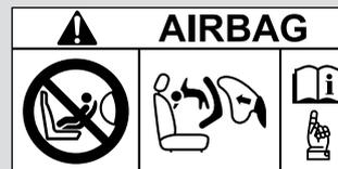
**NÃO coloque um sistema de proteção infantil voltado para trás neste banco equipado com airbag.**
