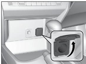
O painel do console dianteiro possui um soquete de alimentação para acessórios. Ele pode ser usado quando o interruptor de ignição estiver na posição **ACESSÓRIOS I** ou **LIGADA III**.
