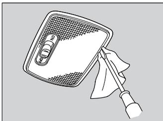
1. Usando uma chave de fenda, levante a borda da tampa para removê-la.
