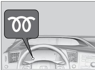
3. Gire o interruptor de ignição para a posição **LIGADA** (II), sem pressionar o pedal do acelerador.
