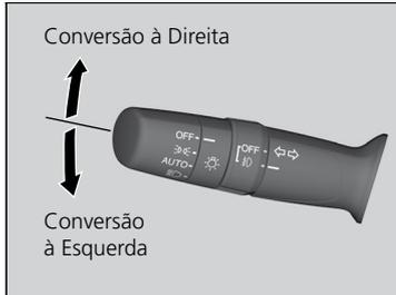
Os sinalizadores de direção podem ser usados quando o interruptor de ignição estiver na posição **LIGADA III**.
