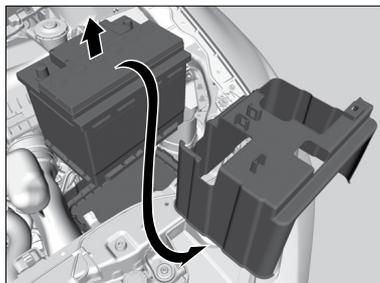
►► Substituição da Bateria
