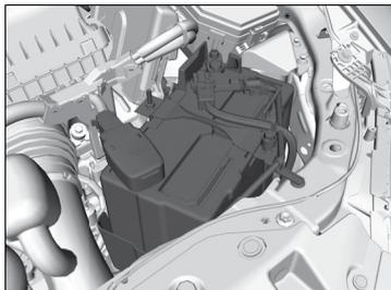
Verifique mensalmente a condição da bateria. Verifique os terminais quanto à corrosão. Se a bateria do veículo for desconectada ou descarregar:
