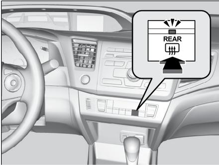
O desembaçador do vidro traseiro desliga automaticamente após 10 a 30 minutos, dependendo da temperatura externa.
