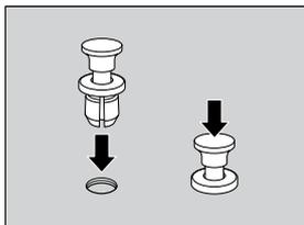
Para inserir, mantenha a cabeça da presilha levantada e pressione até ouvir um clique.
