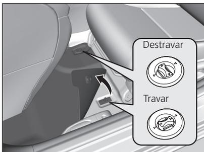
O tapete do motorista é fixado às ancoragens do assoalho, impedindo que escorreguem para a frente. Para remover os tapetes para limpeza, gire os botões de ancoragem para a posição de destravamento, como indicado na figura. Ao reinstalar os tapetes após a limpeza, posicione-os corretamente e gire os botões de ancoragem para a posição de travamento, como indicado na figura.
