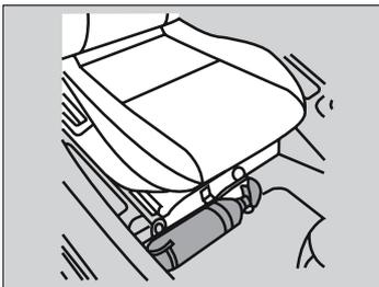
O extintor de incêndio está localizado sob o assento dianteiro, no lado do passageiro dianteiro, fixado à carroceria do veículo.
