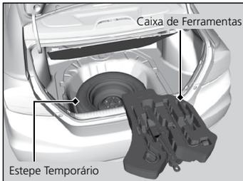
2. Retire a caixa de ferramentas do porta-malas. Retire o macaco e a chave de roda da caixa de ferramentas.
