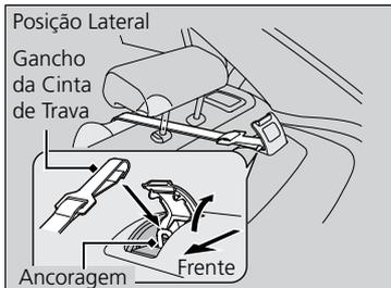
Existe um ponto de ancoragem atrás de cada uma das posições externas do banco traseiro. Um sistema de proteção infantil instalado com cinto de segurança, que seja equipado com trava, pode ser usado para segurança adicional.
