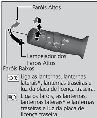
Ao girar o interruptor das luzes, as luzes se acendem e se apagam, independentemente da posição do interruptor de ignição.
