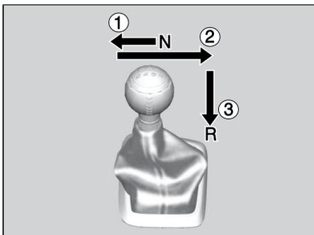
1. Pressione o pedal da embreagem, mova a alavanca de mudanças totalmente para a esquerda, e para a posição **R**.
