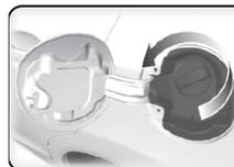
❸ Coloque a tampa no suporte localizado na portinhola de abastecimento do tanque de combustível.
