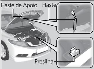
4. Remova a haste de apoio da presilha. Coloque-a no orifício de apoio no capô.
