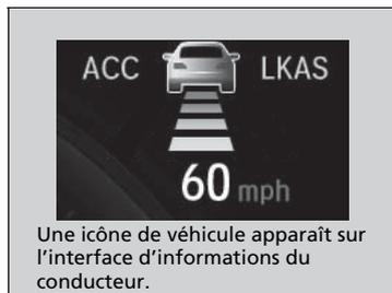
Lorsqu'un autre véhicule circulant devant à une vitesse plus lente que la vitesse de consigne du véhicule est détecté, le véhicule commence à ralentir.
