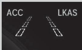
À l'annulation du LKAS, les lignes de voie se transforment en lignes de contour sur l'interface d'informations du conducteur et un signal sonore retentit (si activé).
