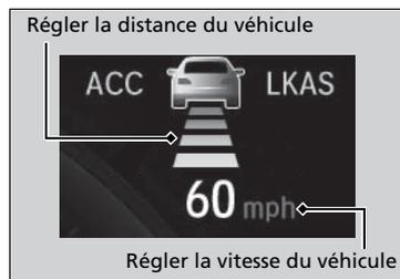
Lorsque l'ACC avec LSF commence à fonctionner, l'icône du véhicule, les barres de distance et la vitesse de consigne apparaissent sur l'interface d'informations du conducteur.
