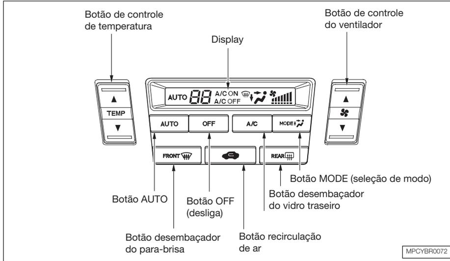
Quando a temperatura é ajustada para o limite mais baixo (L) ou para o limite mais alto (H), o sistema funciona somente em aquecimento total ou ar-condicionado total. Neste ajuste a temperatura no interior do veículo não é ajustada.
