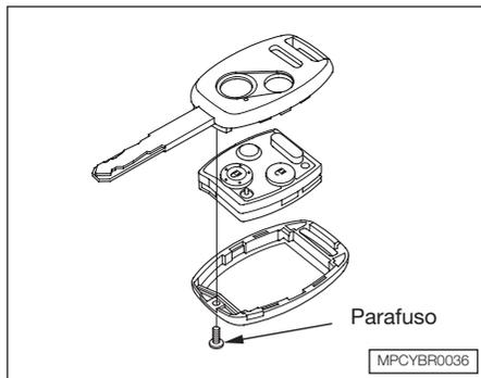
Para substituir a bateria:
