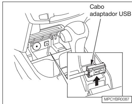
1. O cabo adaptador USB está localizado no porta-objetos. Abra a tampa para alcançar o cabo adaptador.
