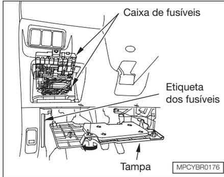
Para acessar a caixa de fusíveis, gire o botão na tampa inferior 1/4 de volta e puxe a frente da tampa para baixo para removê-la do painel.
