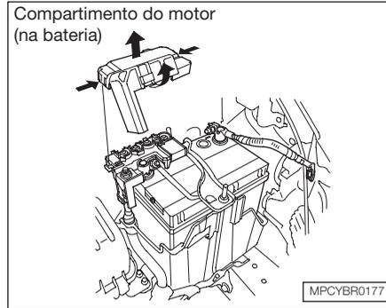
O fusível no compartimento do motor está no terminal positivo da bateria. Para abrir, pressione as linguetas, conforme indicado na ilustração.
