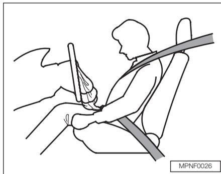
Após o airbag inflar, começará a esvaziar-se imediatamente, e não interferirá em sua visibilidade para operar outros controles. O tempo total para inflar e esvaziar é uma fração de segundo. O acionamento do airbag pode até nem ser notado.
