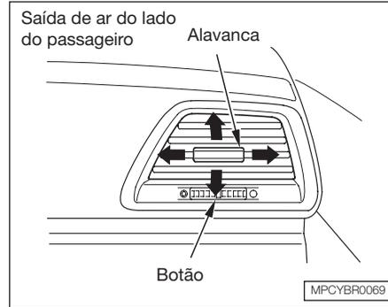
As saídas de ar laterais do painel de instrumentos podem ser abertas e fechadas com os botões existentes debaixo delas.
