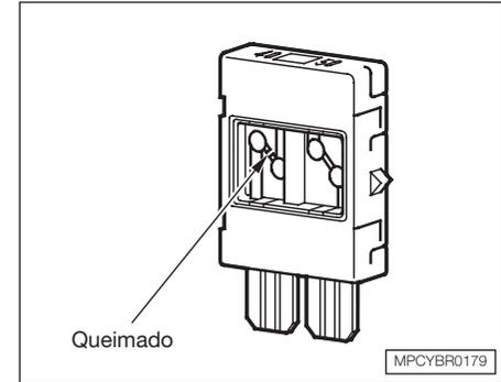
4. Verifique todos os fusíveis maiores na caixa de fusíveis interna, olhando o filamento interno. Para remover estes fusíveis, é necessário uma chave Philips.
