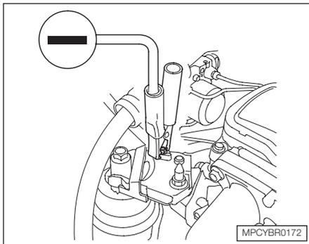
5. Conecte o segundo cabo ao terminal negativo (-) da bateria auxiliar. Conecte a outra extremidade desse cabo no ponto terra, como indica a figura. Não conecte esse cabo em qualquer outra peça do motor.
