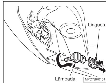
4. Remova o conector elétrico da lâmpada apertando-o para destravar a lingueta e então deslize o conector para fora da lâmpada.
