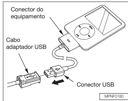
2. Conecte o conector do seu iPod corretamente e com firmeza.
