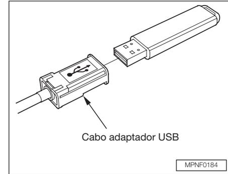
2. Conecte o conector do dispositivo de memória flash USB ao cabo adaptador USB corretamente e firmemente.
