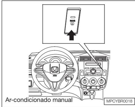
A luz indicadora no botão permanecerá acesa enquanto o desembaçador estiver ligado. Ele desliga quando o interruptor de ignição for desligado.
