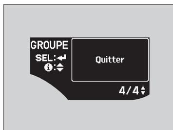
6. Appuyer sur le bouton ▲①/▼ jusqu'à ce que "Quitter" apparaisse sur l'affichage, appuyer ensuite sur le bouton SEL/RESET (sélectionner/réinitialiser).
