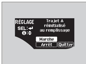
5. Appuyer sur le bouton ▲①/▼ et sélectionner "Marche", appuyer ensuite sur le bouton SEL/RESET (sélectionner/réinitialiser).
