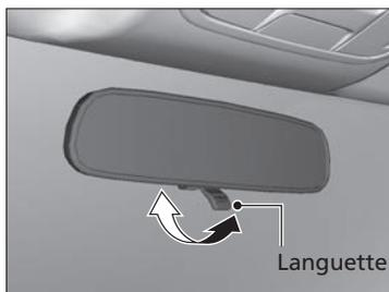
Basculer l'onglet pour changer la position. La position de nuit contribue à réduire l'éblouissement des phares des véhicules suivant derrière lors de la conduite de nuit.
