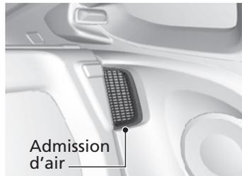
En cas d'obstruction de l'admission d'air pendant le fonctionnement du véhicule, la batterie du système IMA peut surchauffer. Pour protéger la batterie, le système peut commencer à limiter la puissance de sortie de la batterie du système IMA et déclencher l'illumination des témoins du système IMA et du système de chargement de la batterie 12 volt.
