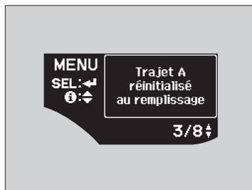
4. Appuyer sur le bouton ▲①/▼ jusqu'à ce que "Trajet A réinitialisé au remplissage" apparaissent sur l'affichage, appuyer ensuite sur le bouton SEL/RESET (sélectionner/réinitialiser).
