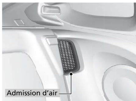
En cas d'obstruction de l'admission d'air pendant le fonctionnement du véhicule, la batterie du système IMA peut surchauffer. Pour protéger la batterie, le système peut commencer à limiter la puissance de sortie de la batterie du système IMA et déclencher l'illumination des témoins du système IMA et du système de chargement de la batterie de 12 volts.
