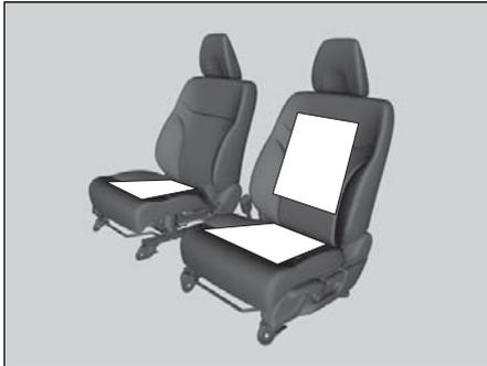
Le commutateur d'allumage doit être en position MARCHE **II** pour utiliser les sièges chauffants. Le réglage HI (haut) réchauffe les sièges plus rapidement que le réglage LO (bas).
