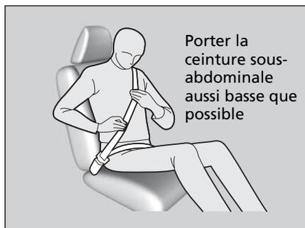
3. Faire passer la partie sous-abdominale de la ceinture aussi basse que possible en travers des hanches, puis tirer sur l'épaulière pour bien ajuster la ceinture. Ceci permet aux os résistants du bassin d'absorber la force d'une collision et réduit ainsi les risques de blessures internes.
