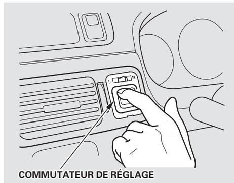
3. Pour déplacer le rétroviseur vers la droite, la gauche, le haut ou le bas, appuyer sur le côté correspondant du commutateur de réglage.
