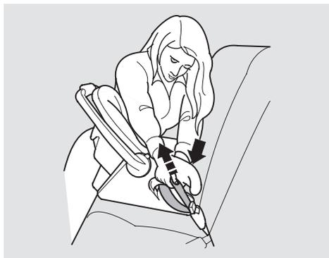
Pour installer un siège d'enfant dos à la route au centre de la banquette arrière avec la ceinture sous-abdominale, suivre les instructions numéro 1 de la page 30 pour attacher et boucler la ceinture de sécurité. Tirer ensuite fermement sur l'extrémité libre de la ceinture pour la tendre (il faut parfois appuyer fortement sur le siège tout en tirant sur la ceinture). Finalement, suivre les instructions numéro 5 de la page 31 pour vérifier si le siège d'enfant est bien fixé.
