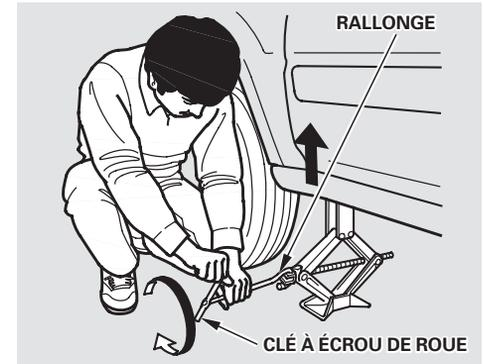
18. Utiliser la rallonge et la clé à écrou de roue tel que représenté pour serrer les écrous de roue jusqu'à ce que le pneu crevé soit décollé du sol.
