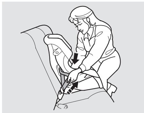
Pour faire asseoir un enfant face à la route au centre de la banquette arrière en utilisant la ceinture sous-abdominale, suivre les instructions numéro 1 de la page 34 pour attacher et boucler la ceinture de sécurité. Tirer ensuite fermement sur l'extrémité libre de la ceinture pour la tendre. Il faut parfois appuyer fortement sur le siège d'enfant tout en tirant sur la ceinture. Finalement, suivre les instructions numéro 5 de la page 35 pour vérifier si le siège d'enfant est bien fixé.
