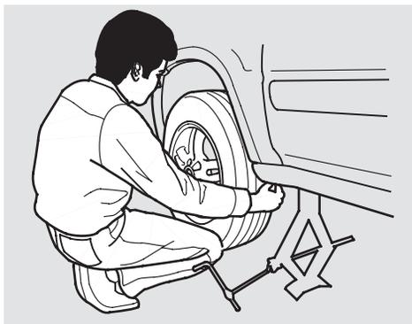
19. Enlever les écrous de roue et le pneu crevé. Déposer provisoirement le pneu crevé et la roue à l'endroit sur le sol. La roue pourrait être égratignée si elle est déposée à l'envers sur le sol.
