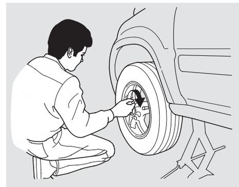
21. Installer le pneu de secours. Visser tout d'abord les écrous à la main puis les serrer à la diagonale avec la clé à écrous de roue jusqu'à ce que la roue soit fermement en contact avec le moyeu. Attendre avant de serrer les écrous à fond.
