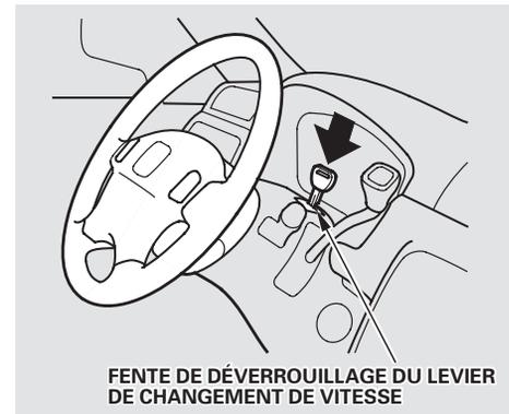
6. Sortir la clé de la fente de déverrouillage du levier de changement de vitesse et remettre le couvercle en place. Enfoncer la pédale des freins et remettre le moteur en marche.
