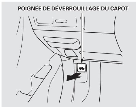
1. Passez le levier de changement de vitesse à la position P (parking) ou N (neutre) et serrer le frein de stationnement. Tirer la poignée de déverrouillage du capot située dans le coin inférieur gauche sous le tableau de bord. Le capot s'entrouvre.
