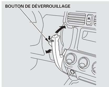
Pour desserrer le frein de stationnement, appuyer de manière continue sur le bouton de desserrement sur le côté du levier du frein de stationnement, tirer légèrement le levier vers soi puis pousser le levier vers l'avant.
