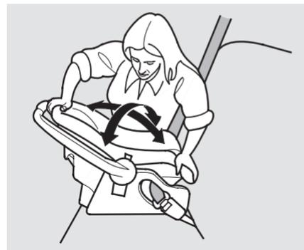
6. Pousser et tirer le siège d'enfant vers l'avant et d'un côté et de l'autre pour vérifier s'il est attaché comme il faut pour rester bien droit pendant les manoeuvres normales du véhicule. S'il bouge, détacher la ceinture et la laisser s'enrouler, puis répéter les étapes d'installation.
