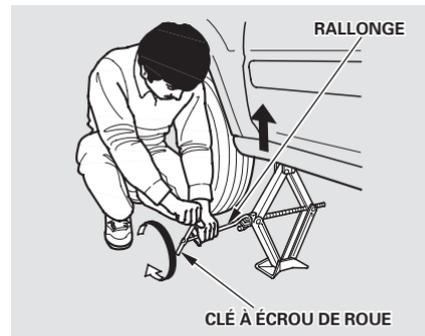
17. Utiliser la rallonge et la clé à écrou de roue tel que représenté pour soulever le véhicule jusqu'à ce que le pneu crevé soit décollé du sol.
