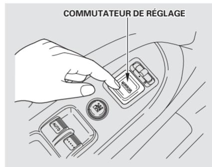
3. Pour déplacer le rétroviseur vers la droite, la gauche, le haut ou le bas, appuyer sur le côté correspondant de l'interrupteur de réglage.
