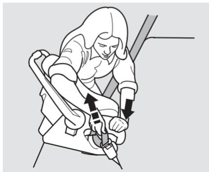
5. Après s'être assuré que la ceinture est verrouillée, saisir le baudrier près du fermoir et tirer dessus pour tendre la ceinture sous-abdominale. Si la ceinture sous-abdominale est mal tendue, le siège d'enfant ne sera pas bien fixé. Pour tendre la ceinture, il est parfois nécessaire d'appuyer fortement sur le siège enfant ou sur le dossier du siège tout en tirant sur la ceinture.
