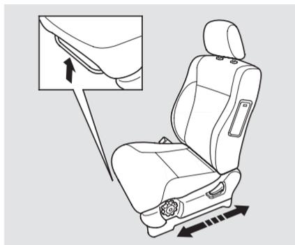
Pour avancer ou reculer le siège, tirer le levier sous le bord avant du coussin du siège. Déplacer le siège à la position désirée et relâcher le levier. Essayer de déplacer le siège pour s'assurer qu'il est verrouillé en place.
