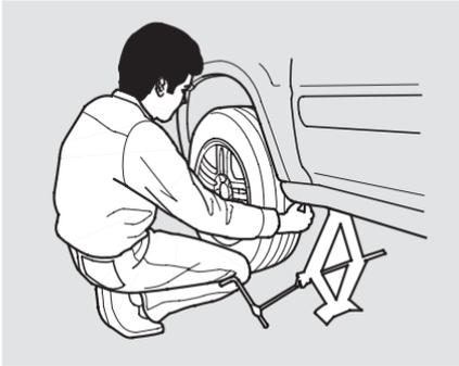
18. Enlever les écrous de roue et le pneu crevé. Déposer provisoirement le pneu crevé et la roue à l'endroit sur le sol. La roue pourrait être égratignée si elle est déposée à l'envers sur le sol.
