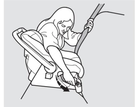
2. Après avoir installé le siège d'enfant à la position arrière souhaitée, faire passer la ceinture dans le siège conformément aux instructions du fabricant, puis insérer la languette dans le fermoir.
