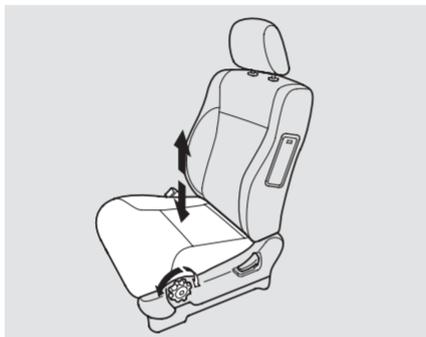
Pour régler la hauteur du siège du conducteur, tourner la molette sur le côté extérieur du bas du siège.
