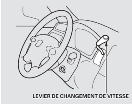
Le levier de changement de vitesse comporte six positions. Le placer sur P ou N pour mettre le moteur en marche. Lors d'un arrêt sur D, 2, 1, N ou R, appuyer fermement sur la pédale de frein et relâcher la pédale d'accélérateur.
