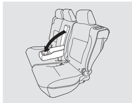
L'accoudoir du siège arrière est au centre du siège arrière. Pour l'utiliser, le faire pivoter vers le bas.
