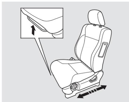
Pour avancer ou reculer le siège avant ou arrière, tirer sur la tringle sous la bordure avant du coussin du siège. Puis, essayer de déplacer le siège pour assurer qu'il est bien enclenché.
