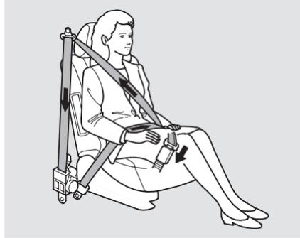
Pour une meilleure protection, les ceintures de sécurité avant sont équipées d'enrouleurs automatiques. Lorsqu'ils sont activés, ces dispositifs tendent immédiatement les ceintures afin de retenir le conducteur et le passager avant en place.
