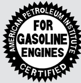
L'huile à moteur Honda est le lubrifiant 5W-20 préféré pour ce véhicule. Il est fortement recommandé d'utiliser l'huile à moteur Honda dans ce véhicule pour une protection maximale du moteur. Assurer que le sceau de certification API porte la mention "pour moteurs à essence".
