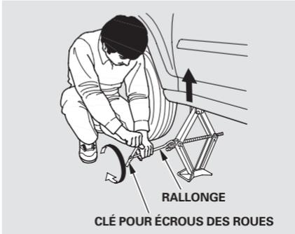
12. Utiliser la rallonge et la clé pour écrou de roue tel que représenté pour soulever le véhicule jusqu'à ce que le pneu crevé soit éloigné du sol.
