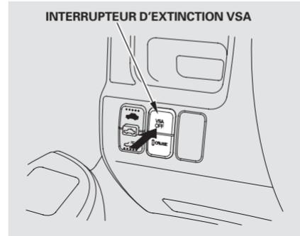
Cet interrupteur est sous la bouche d'air gauche. Appuyer sur cet interrupteur pour activer et désactiver le système d'assistance de la stabilité du véhicule.
