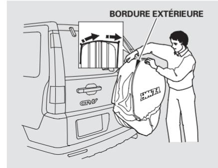
25. A partir du haut du pneu, mettre le bord extérieur de la housse sur le bord extérieur du pneu. Recouvrir le pneu de la housse en travaillant graduellement et en alternant les côtés jusqu'au bas.
