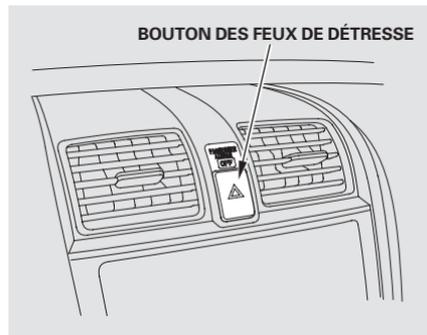
Enfoncer le bouton entre les bouches d'air centrales pour allumer les feux de détresse (multicligotants en quatre sens). Cela fait clignoter les quatre feux de virage extérieurs et les deux témoins du tableau de bord. Utiliser les feux de détresse s'il faut stationner de manière précaire à proximité de la circulation ou si le véhicule est en panne.
