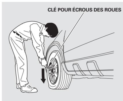
7. Desserrer chaque écrou de roue un demi-tour avec la clé pour écrou de roue.
