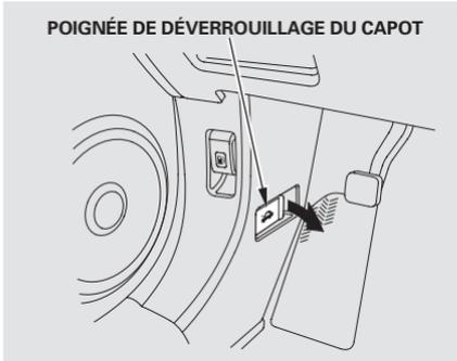
1. Stationner le véhicule et serrer le frein de stationnement. Tirer la poignée de déverrouillage du capot située dans le coin inférieur gauche sous le tableau de bord. Le capot s'ouvre.
