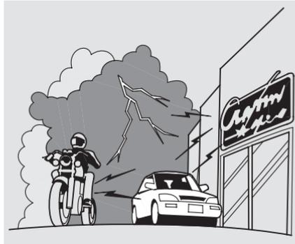
La réception de la radio peut être perturbée par certaines conditions atmosphériques telles les orages, la forte humidité et les taches solaires. Il est possible de recevoir une station lointaine un jour et non le lendemain à cause du changement des conditions atmosphériques.
