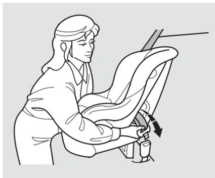
1. Quand le siège d'enfant est à la position souhaitée à l'arrière, faire passer la ceinture de sécurité dans le siège conformément aux directives du fabricant du siège puis insérer la languette dans le fermoir.
