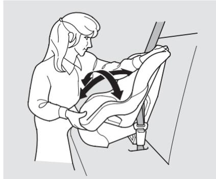
5. Pousser et tirer le siège d'enfant vers l'avant et d'un côté de l'autre pour confirmer qu'il reste parfaitement en place lors de manoeuvres normales. Si le siège d'enfant n'est pas assez solide, détacher la ceinture, la laisser s'enrouler complètement puis répéter ces étapes.
