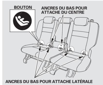
Quand on installe un siège d'enfant au centre du siège arrière, il faut utiliser les ancres centrales du bas tel que représenté. Pour installer un siège d'enfant d'un côté ou de l'autre, utiliser les ancres latérales du bas. On peut installer jusqu'à deux sièges d'enfant à la fois en utilisant les ancres latérales du bas.
