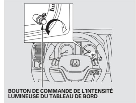
La luminosité du tableau de bord ne peut être changée que lorsque l'interrupteur des phares est en circuit.
