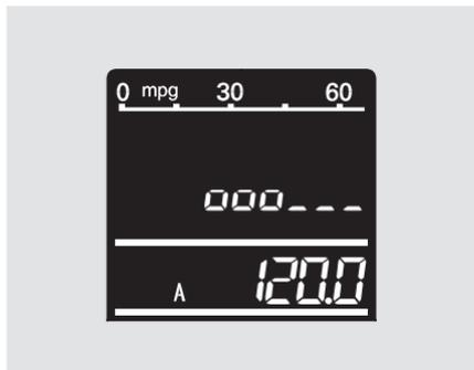
Pour réduire l'éblouissement le soir, la luminosité du tableau de bord diminue quand l'interrupteur d'éclairage est sur  $\text{☾}$  ou  $\text{☾}$ . Tourner le bouton "Select/Reset" complètement vers la droite jusqu'au signal sonore pour annuler la luminosité réduite.
