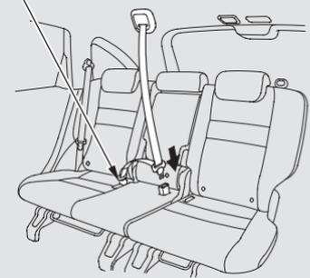
La ceinture abdominale/baudrier de la position centrale du siège arrière est équipée d'une ceinture de sécurité amovible qui compte deux parties: une petite languette d'attache et une boucle d'ancrage.
