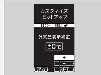
表示されている補正温度（工場出荷時は±0℃）より高めに設定したい場合は、インフォメーション (i) スイッチで「+」を選択し、**SEL/RESET** を引いて1℃ずつ補正温度を上げます。希望の温度になったらインフォメーション (i) スイッチで「SET」を選択し、**SEL/RESET** を引いて設定を完了します。
