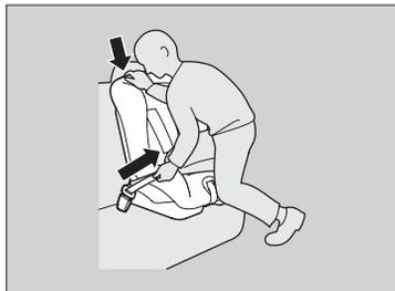
6. チャイルドシートに体重をかけて、シートに押しつけながらベルトを巻き取らせ、固定をする。
