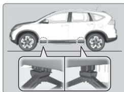
2. Tourner le support du bout vers la droite, tel que montré sur l'image jusqu'à ce que le dessus du cric touche le point de levage. S'assurer que la languette du point de levage repose dans l'encoche du cric.
