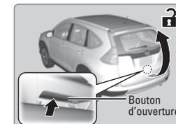
**Pour verrouiller :** Appuyer sur le bouton de verrouillage du hayon afin de verrouiller le hayon et toutes les portières. Si la télécommande se trouve à l'intérieur du véhicule, le hayon et les portières ne pourront se verrouiller.
