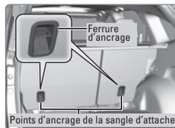
**Utilisation de l'ancrage central :** Abaisser l'appuie-tête à sa position la plus basse. Ouvrir le couvercle de l'ancrage. Passer la sangle d'attache entre les tiges de l'appuie-tête.
