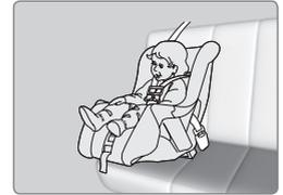
Le fait de placer un siège de sécurité pour enfant faisant face à l'avant sur le siège avant peut être dangereux, même avec des coussins gonflables avant de pointe qui désactivent automatiquement le coussin gonflable du passager avant. Une place à l'arrière demeure l'endroit le plus sécuritaire pour un enfant.
