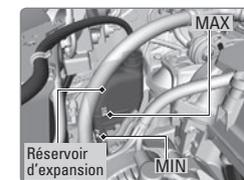
Une fois que le moteur est suffisamment refroidi, redémarrer et surveiller l'indicateur de température. Si l'aiguille de la température est redescendue, reprendre la conduite. Dans le cas contraire, communiquer avec un concessionnaire pour faire réparer le véhicule.
