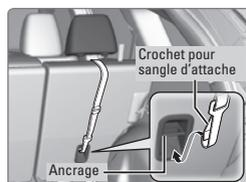
2. Fixer le crochet de la sangle d'attache dans l'ancrage.
