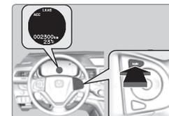
2. Appuyer sur le bouton LKAS. Les lignes extérieures de la voie apparaissent sur l'affichage multifonctions. Les lignes de voie pointillées deviennent continues lorsque le système est activé.
