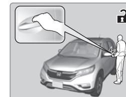
**Pour verrouiller :** Appuyer sur le bouton de verrouillage de portière de la poignée de portière avant lorsque le véhicule est éteint. Si la télécommande se trouve à l'intérieur du véhicule, les portières ne pourront se verrouiller.
