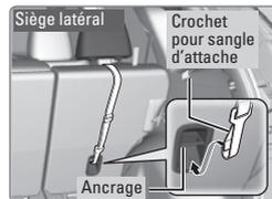
4. Serrer la sangle d'attache conformément aux directives du fabricant du siège.
