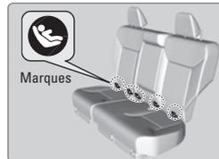
2. Mettre le siège de sécurité pour enfant sur le siège du véhicule, puis attacher le siège aux ancrages inférieurs conformément aux directives accompagnant le siège de sécurité pour enfant. S'assurer que les ancrages inférieurs ne sont pas obstrués par une ceinture de sécurité ou par tout autre objet.
