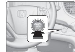
**Éteindre le véhicule** : Placer le levier de vitesses en position P (stationnement), puis appuyer sur le bouton ENGINE START/STOP (mise en marche/arrêt du moteur). Si on appuie sur le bouton et que le levier de vitesses n'est pas en position P (stationnement), le véhicule passe en mode accessoire.
