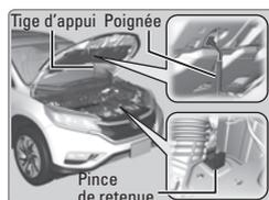
En refermant, retirer la tige d'appui et la replacer dans la pince de retenue, puis abaisser doucement le capot. Retirer sa main à une hauteur d'environ 30 cm (12 po) et laisser le capot se refermer.
