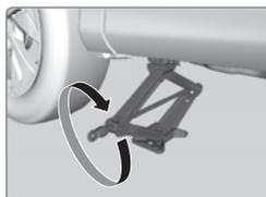
3. Soulever le véhicule en utilisant la barre et le manche de cric, jusqu'à ce que le pneu ne touche plus au sol.
