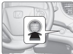
Le volant de direction ne se verrouillera pas. Le mode d'alimentation passe à ACCESSOIRE, à moins que le levier de vitesses ne se trouve à la position P (stationnement). Dans ce cas, le mode d'alimentation passe à CONTACT COUPÉ.
