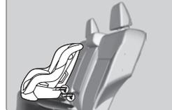
**Pour le siège central :** Abaisser l'appuie-tête à sa position la plus basse. Ouvrir le couvercle de l'ancrage. Passer la sangle d'attache par-dessus l'appuie-tête.
