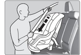
3. Tirer la partie épaulière de la ceinture lentement et complètement jusqu'à ce qu'elle s'arrête. Cela active le mécanisme de blocage.
