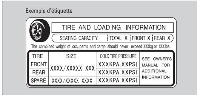
Ce résultat inclut le poids total de tous les occupants, des bagages, des accessoires et de la charge sur la flèche d'attelage si on tire une remorque. Voici la marche à suivre permettant de déterminer la capacité de charge :
