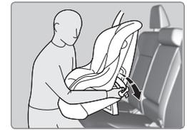
2. Faire passer la ceinture de sécurité dans le siège de sécurité pour enfant conformément aux directives du fabricant du siège, puis insérer la patte de fixation dans la boucle. Insérer complètement la patte de fixation jusqu'à ce qu'elle s'enclenche.
