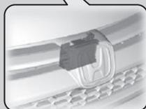
Le capteur radar est à l'intérieur de la calandre avant.
