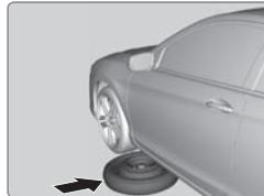
4. Placer le pneu de secours compact (roue vers le haut) sous la carrosserie du véhicule, près du pneu à remplacer.
