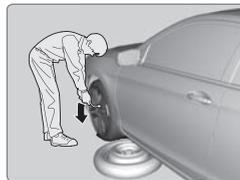
5. Desserrer chaque écrou de roue d'environ un tour en utilisant la clé pour écrou de roue.
