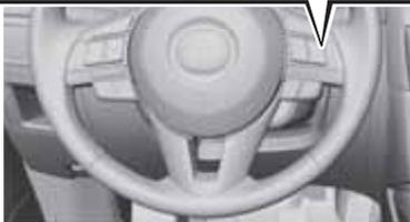
Quando o interruptor ON é pressionado, a velocidade do veículo e a distância entre veículos durante o controlo da distância pode ser definida. A indicação do Controlo da Velocidade de Cruzeiro de Radar Mazda (MRCC) é visualizada no ecrã no painel de instrumentos.
