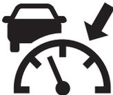
La advertencia se enciende si hay un malfuncionamiento en el sistema mientras el Control de cruceo de radar de Mazda (MRCC) está encendido. Haga inspeccionar su vehículo en un técnico experto, le recomendamos un técnico autorizado Mazda.
