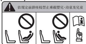
Incluso en caso de un choque moderado, el sistema de seguridad para niños puede ser golpeado al inflarse una bolsa de aire y puede ser movido violentamente hacia atrás resultando en heridas graves o la muerte del niño. Si su vehículo está equipado con un interruptor de desactivación de bolsa de aire del acompañante, siempre ajuste el interruptor a la posición OFF al instalar el sistema de seguridad para niños mirando hacia atrás en el asiento del acompañante.
