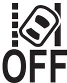
Oprima el interruptor del sistema de asistencia de mantención en carril para cancelar el sistema de asistencia de mantención en carril. Se exhibe la indicación de sistema de asistencia de mantención en carril OFF. Si se continúa exhibiendo la indicación incluso después de haber usado el interruptor de sistema de asistencia de mantención en carril, indica que hay un problema en el sistema. Haga inspeccionar su vehículo en un técnico experto, le recomendamos un técnico autorizado Mazda.
