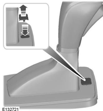
Use el botón para mover la palanca selectora desde la posición de estacionamiento en el caso que haya un malfuncionamiento eléctrico o si se le ha descargado la batería a su vehículo.
