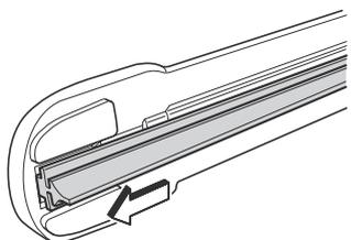
8. Asegúrese que el caucho de la escobilla está instalado correctamente en el soporte de la escobilla.
