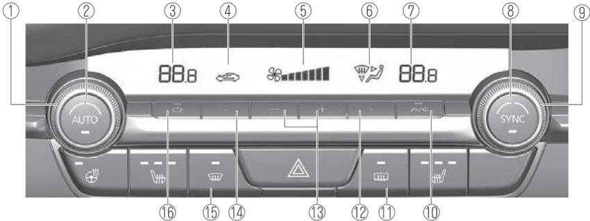
1. Dial de control de temperatura del conductor
