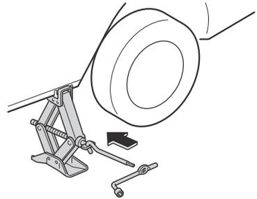
8. Gire la manija del gato hacia la derecha y levante el vehículo lo suficientemente alto como para instalar el neumático de repuesto. Antes de quitar las tuercas de orejeta, verifique que el vehículo se encuentre en una posición estable y que no se puede deslizar ni mover.
