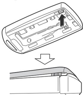
3. Inserte un destornillador de punta plana envuelto en cinta en la ranura y deslícelo en la dirección de la flecha.
