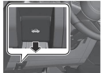
2. Inserte su mano en la abertura del capó, deslice la palanca del seguro hacia la izquierda y levante el capó.
