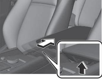
Para abrir la tapa, tire de la perilla, deslice la tapa hacia atrás y elévela.
