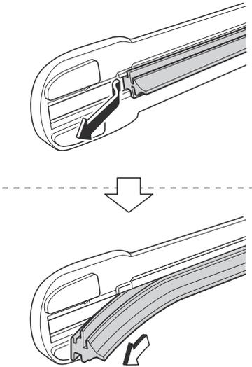
6. Inserte el extremo del caucho de la hoja nueva en la ranura del soporte de la hoja hasta que haga contacto con el extremo del soporte de la hoja.
