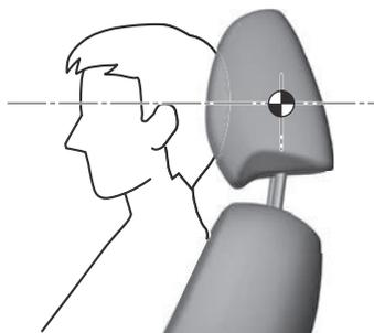
Para levantar el reposacabezas, tire del mismo hasta dejarlo en la posición deseada.
