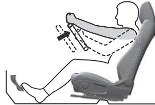
2. Ajuste la altura del volante de forma que los indicadores se puedan ver fácilmente.
