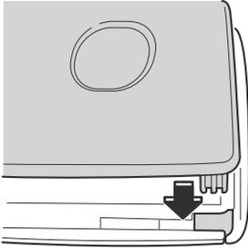
10. Inserte las pestañas de la cubierta inferior en las ranuras del transmisor e instale la cubierta inferior.
