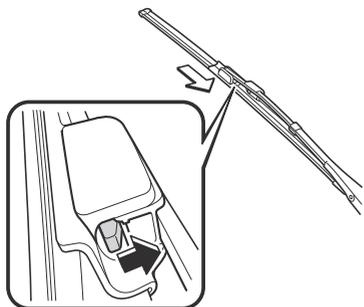
4. Tire del caucho de la escobilla en la dirección de la flecha y deslícela a una posición donde se pueda verificar la ranura del soporte de la escobilla.
