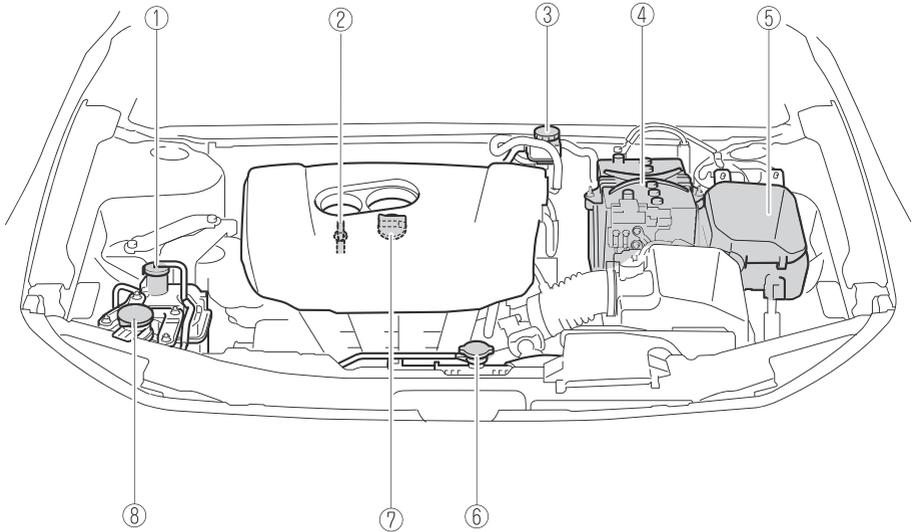
1. Depósito de refrigerante del motor
