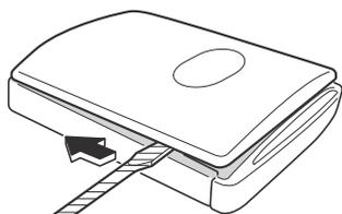
4. Inserte y gire en la dirección de la flecha el destornillador de punta plana envuelto en cinta y retire la cubierta superior.
