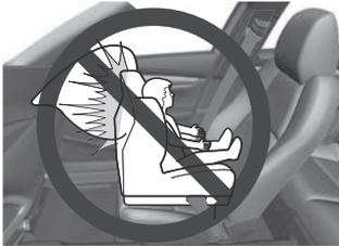
**No instale un sistema de seguridad para niños mirando hacia delante en el asiento del pasajero a menos que sea inevitable:**
