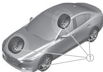
1. Sensores de presión de aire de los neumáticos
