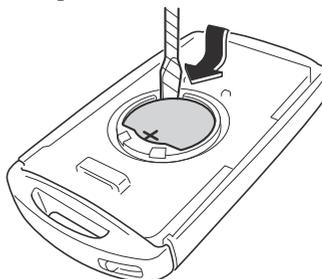
7. Introduzca una nueva batería en el transmisor de forma que el polo positivo quede mirando hacia arriba.
