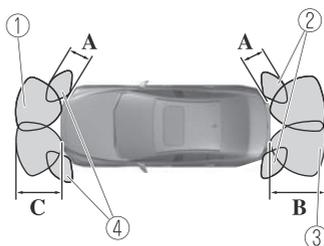
1. Rango de detección de sensor ultrasónico delantero
