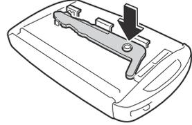
2. Inserte las pestañas de la cubierta inferior en las ranuras del transmisor e instale la cubierta inferior.
