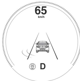
**Visualizador de conducción activa (vehículos con visualización de conducción activa)**
