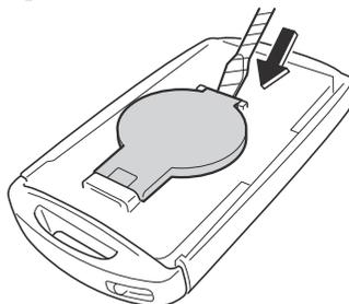
6. Retire la batería con el destornillador de punta plana envuelto en cinta.
