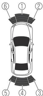
1. Indicador del sensor ultrasónico delantero\*
