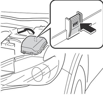
3. Si hay un fusible diferente del fusible MAIN fundido, cámbielo por uno nuevo **con las mismas especificaciones de amperaje.**
