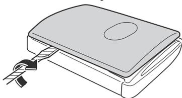
5. Retire la tapa con el destornillador de punta plana envuelto en cinta.
