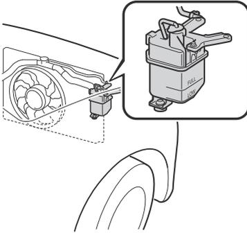
Si está en o cerca de la marca LOW, agregue suficiente refrigerante anticongelante y anticorrosivo en el depósito de refrigerante para llevar el nivel hasta la marca FULL.
