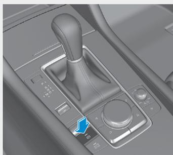
Se o interruptor EPB for pressionado sem pressionar o pedal dos travões, é indicada uma mensagem no ecrã multi-informação para notificar o condutor para pressionar o pedal dos travões.
