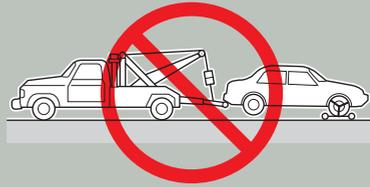
Se o serviço de reboque não estiver disponível durante uma emergência, o veículo poderá ser rebocado com todas as rodas em contacto com o solo, utilizando o gancho de reboque na dianteira do veículo.
