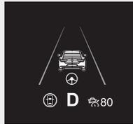
2. Ajuste a velocidade do veículo para o valor desejado utilizando o pedal do acelerador e pressione o interruptor RES para cima (SET+) ou para baixo (SET-) para iniciar o controlo da distância.
