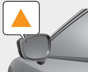
Quando a ignição é colocada na posição ON, a luz indicadora de aviso liga momentaneamente e desliga após alguns segundos.
