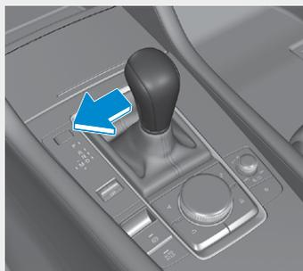
Para voltar ao modo engrenamento automático, mova a alavanca de velocidades da gama M para a gama D.
