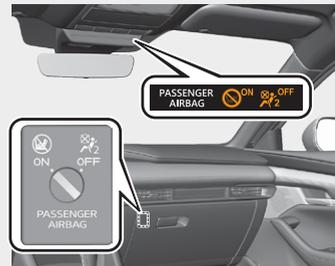
No caso de montar um sistema de retenção para crianças no banco do passageiro dianteiro, o interruptor de desativação do airbag do passageiro deve ser utilizado para desativar os airbags dianteiro e lateral do passageiro dianteiro assim como o sistema pré-tensor do cinto de segurança.
