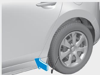
2. Allentare i dadi della ruota, ruotando ciascuno di essi di un giro in senso antiorario, ma non toglierli finché la ruota non si è staccata da terra.
