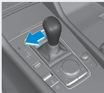
Per tornare alla modalità cambiate automatiche, spostare la leva dalla posizione M alla posizione D.
