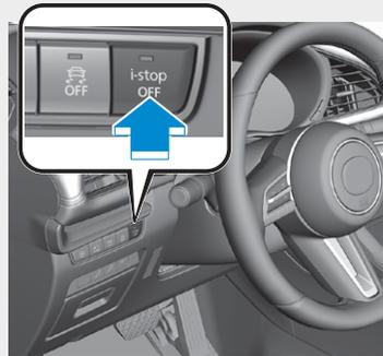
Premendo l'interruttore fino all'emissione di un segnale acustico, la funzione i-stop si spegne. Premendo di nuovo l'interruttore fino all'emissione di un segnale acustico, la funzione i-stop ritorna operativa.
