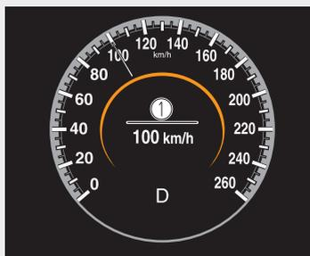
1. Viene visualizzato il messaggio "Avviso velocità"
