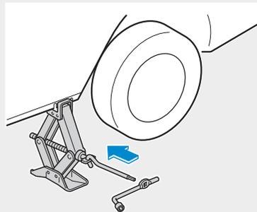
8. Ruotare in senso orario la manovella del martinetto e sollevare il veicolo quanto basta per poter installare la ruota di scorta. Prima di rimuovere i dadi della ruota, assicurarsi che la sua Mazda sia saldamente ferma e non possa scivolare o muoversi.
