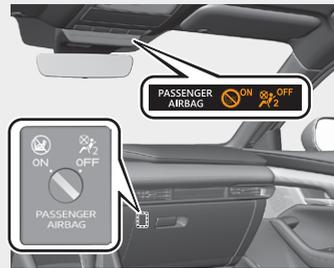
L'interruttore di disattivazione airbag passeggero anteriore serve per disattivare gli airbag frontale e laterale del passeggero anteriore, nonché il sistema pretensionatore della relativa cintura di sicurezza, quando s'installa un seggiolino per bambini sul sedile del passeggero anteriore.
